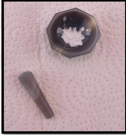
Şekil 3.22. XRD analizi öncesi agat havanda ezilen numuneler
