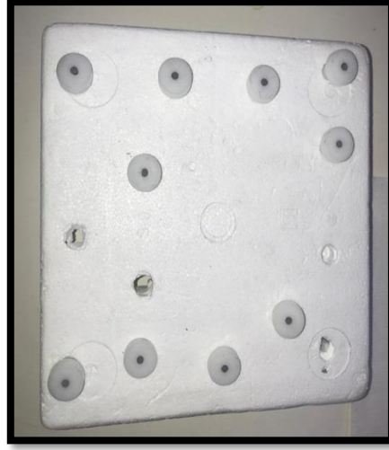
Şekil 3.5. 4mm çap ve 2mm kalınlığa sahip kalıplar kullanılarak karıştırılmış materyal örnekleri
