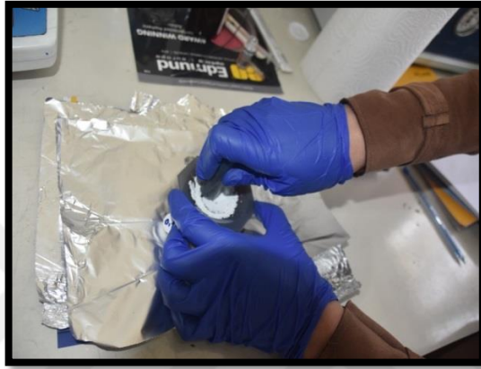
Şekil 3.3. GNP ve MTA'nın havanda ezilerek karıştırılması
