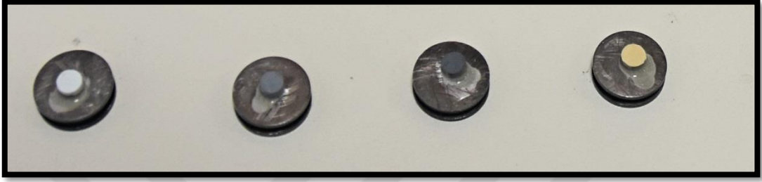
Şekil 3.16. Au-Pd ile kaplanmış örnekler
