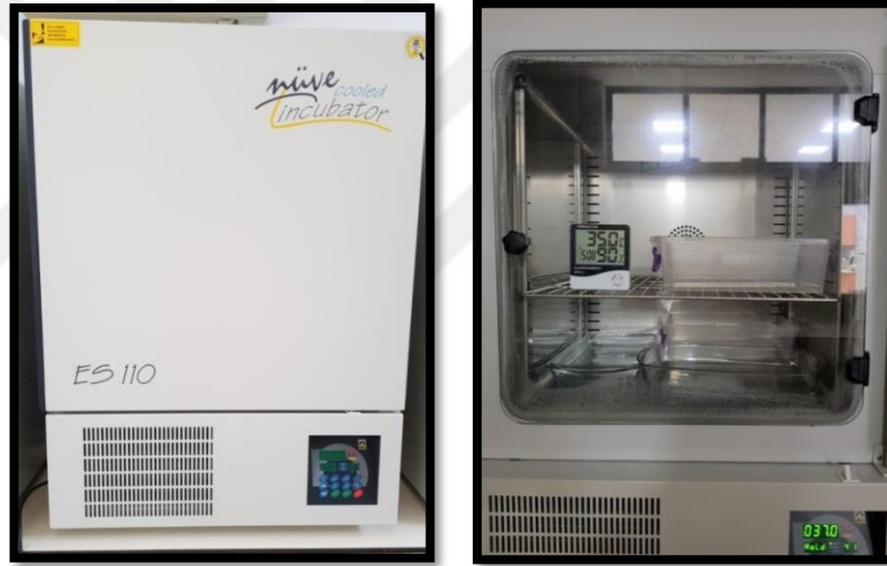
Şekil 3.6. Örneklerin 48 saat 37 °C 90 ± 5% nemde tutulduğu etüv
