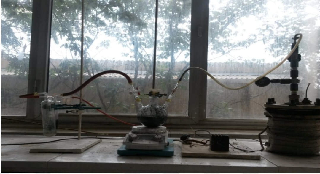
Şekil 4.15. Bulamaç Halindeki Karışımın Sülfürlenmesi Düzenegi
