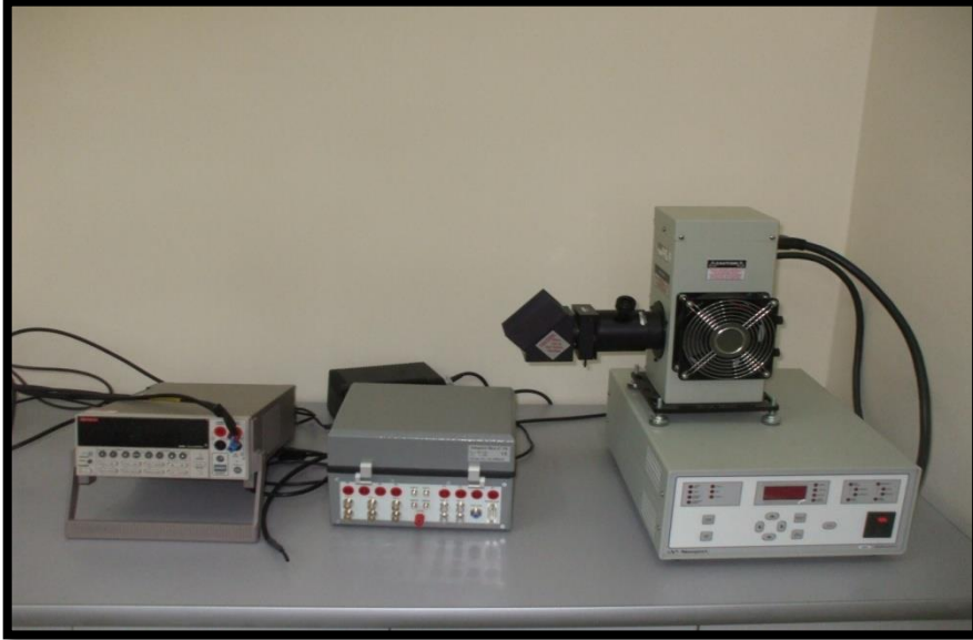
Şekil 3.18. Keithley 2400 ve güneş simülatöründen oluşan ölçüm sistemi
