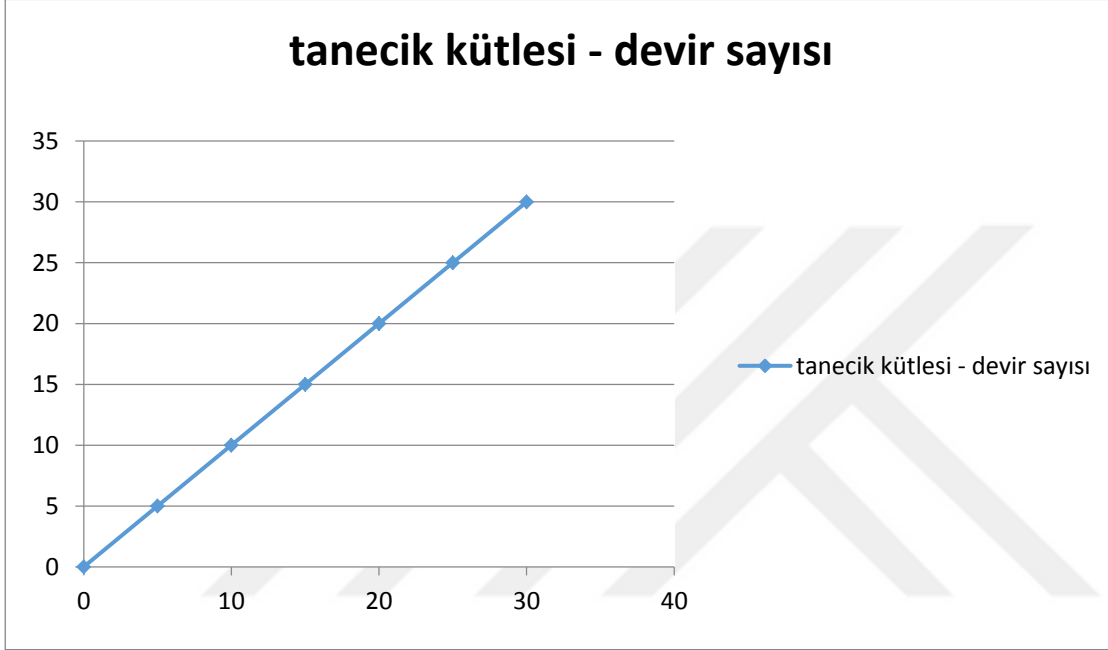
Şekil 3.9. Tanecik kütlesine karşılık devir sayısının grafiği. Grafikte y eksenini tanecik kütlesine, x eksenini ise devir sayısına aittir. 30 devirlik \text{Si}_2\text{H}_6 ve \text{WF}_6 reaktifleri kullanılarak W ALD esnasında QCM ile taneciğin kütlesi görüntülenmiştir. Tungsten kalınlığı ise yoğunluk 19.3 \text{ g/cm}^3 kabul edilerek hesaplanmıştır (Fabreguette ve ark. 2005).
