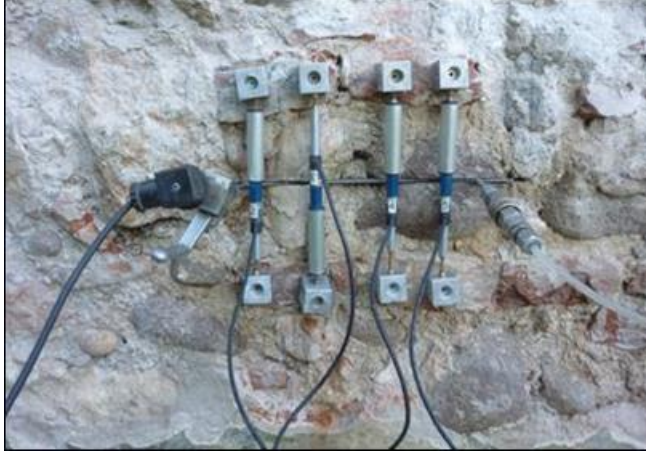
Şekil 3.58. Flat Jack deney düzeneği (Structural Diagnostic, expin.it)
