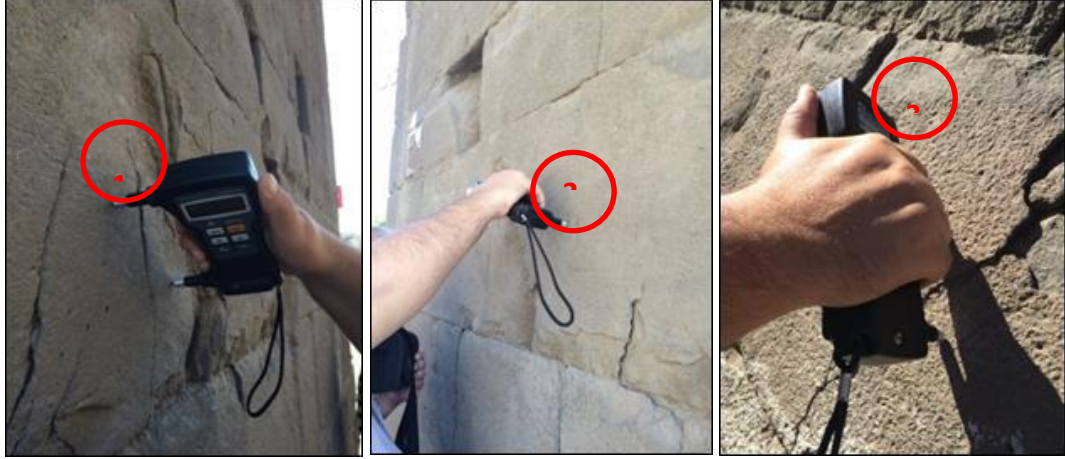
Şekil 4.166. Urfa Kapı'da belirlenen üç ayrı noktada düşük frekanslı ultrasonik test cihazıyla yapılan çatlak, yüzey düzgünlüğü, ses yayılma süresi ve ses yayılma hız ölçümleri
