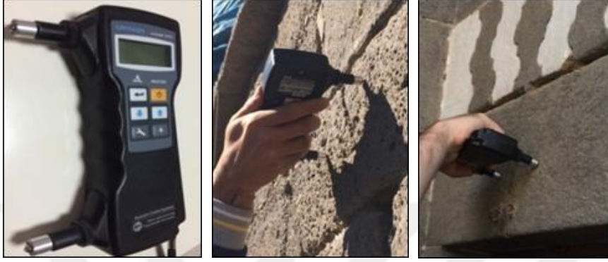
Şekil 4.156. Düşük frekanslı ultrasonik test cihazı ve yapılan ölçümler
