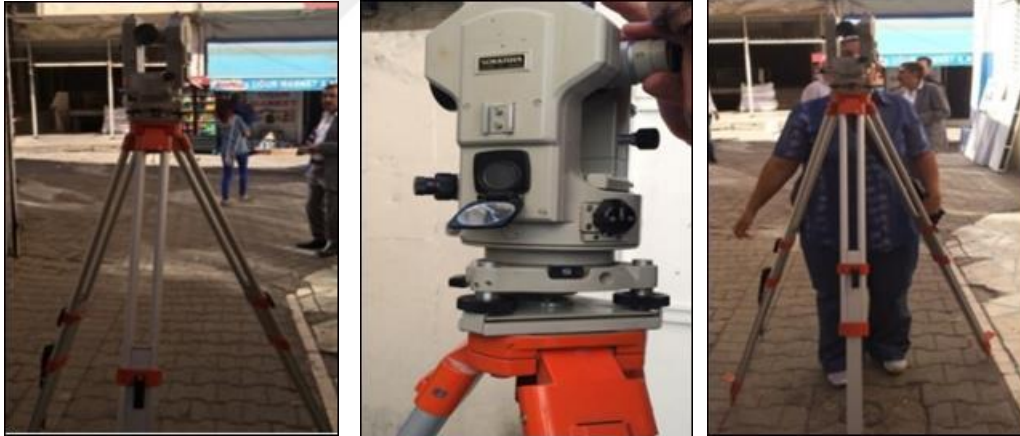
Şekil 4.159. Geleneksel yığma yapılarda aks kaymasının total station (teodolit) cihazı ile belirlenmesi
