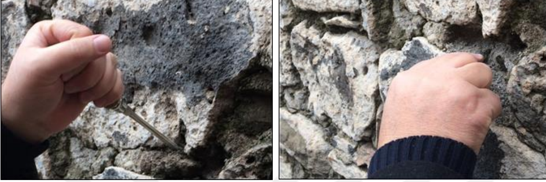
Şekil 3.61. Duvarlardan basit aletlerle harç numunesi alınması
