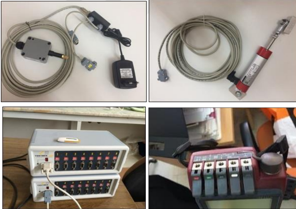
Şekil 4.162. Laboratuvarında kullanılan çatlak ölçer, sıcaklık- nem ölçer ve data logger (veri kaydedici) cihazları
