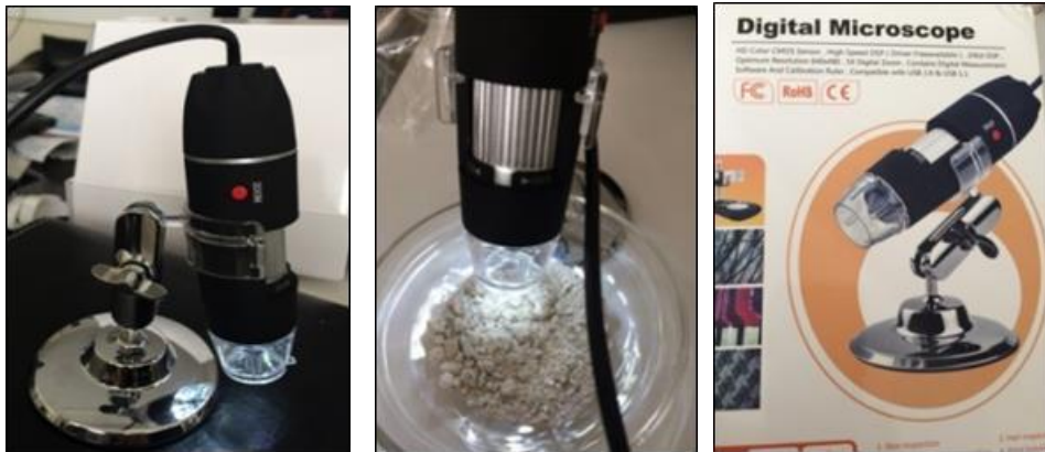
Şekil 4.161. Harç ve sıva numunelerinin iç yapı analizlerinin yapıldığı dijital mikroskop
