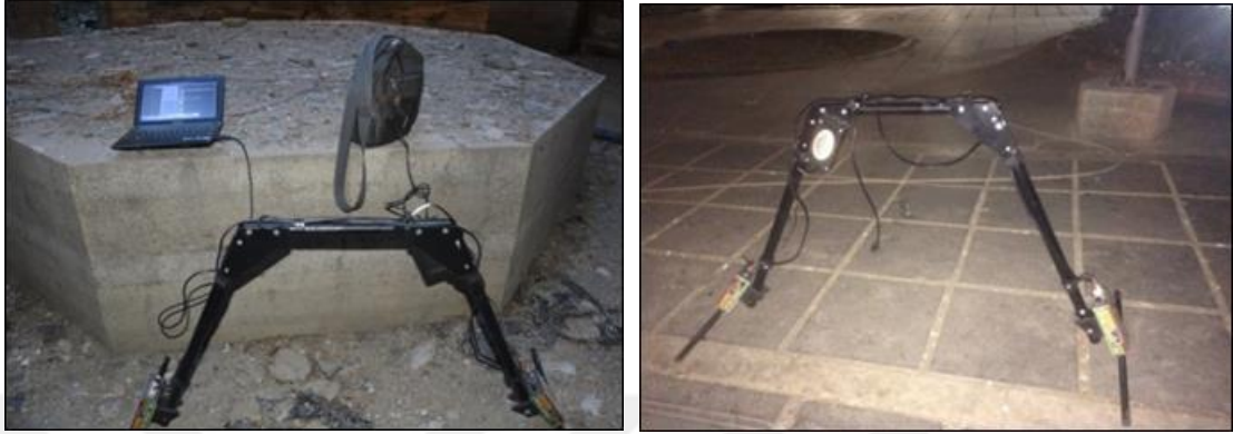
Şekil 4.160. Zemin ve temel kotlarının belirlenmesinde kullanılan yer radarı (GPR) cihazı
