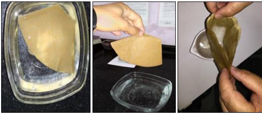
Şekil 4.2243 Horasan harcı numunesinde yapılan su emme oranı tayini deneyi
