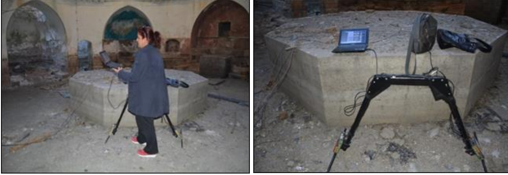
Şekil 4.215. Deva Hamamında Georadar (GPR) cihazıyla yapılan ölçümler
