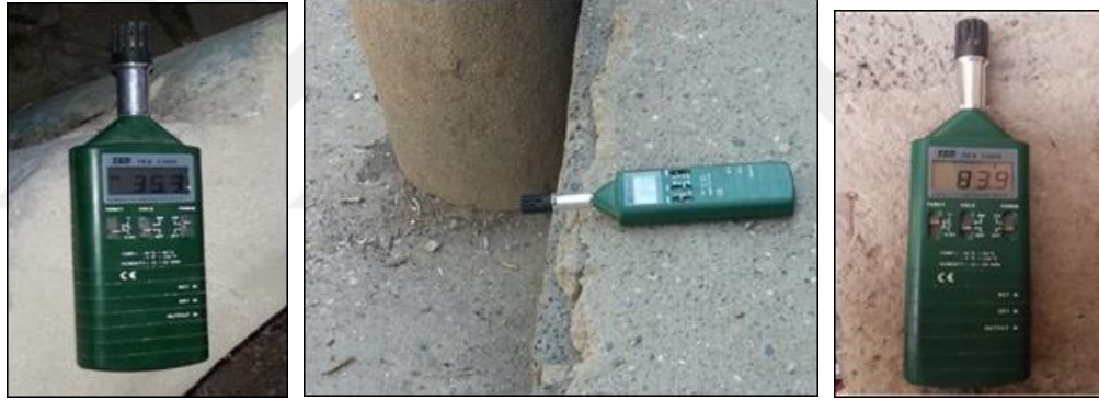
Şekil 4.157. Dijital sıcaklık ve nem ölçüm cihazı
