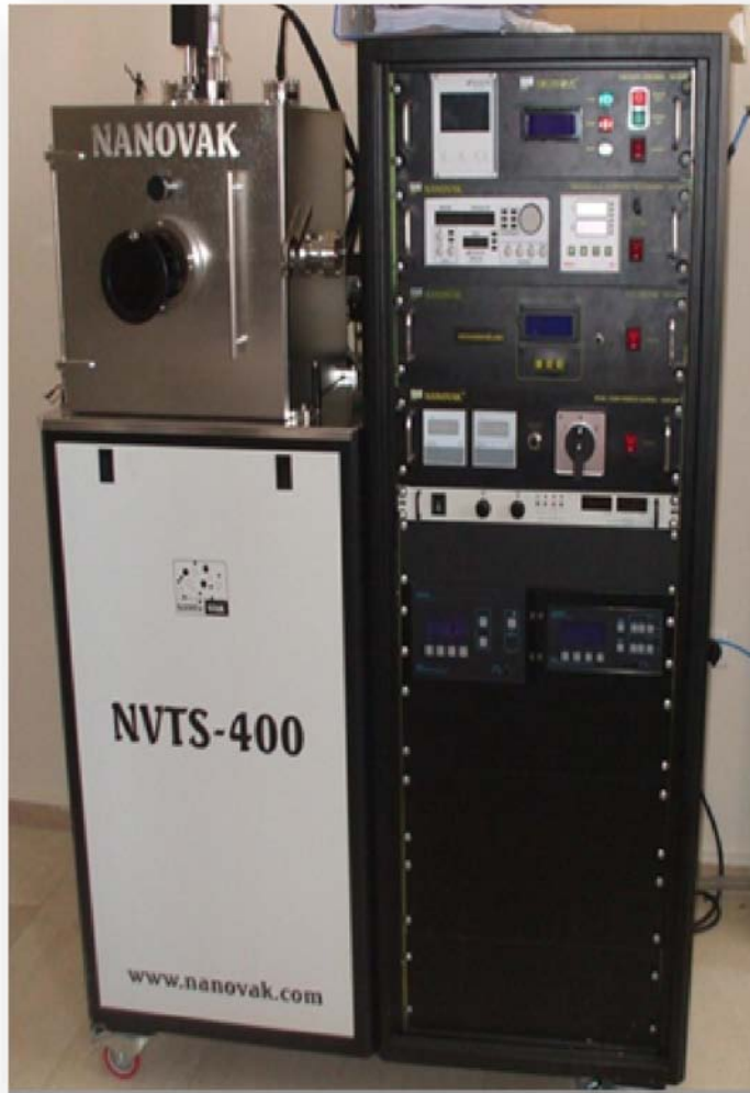
Şekil 3.14. Saçtırma İşlemlerinin gerçekleştirildiği vakum sistemi
