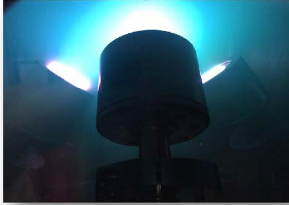
Şekil 3.15. Eş zamanlı saçıtırma işlemi
