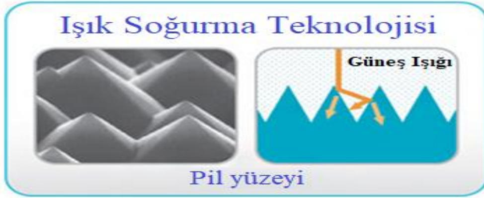
Şekil. 2.2. Piramit yüzeylerde ışığın daha fazla soğurulması
