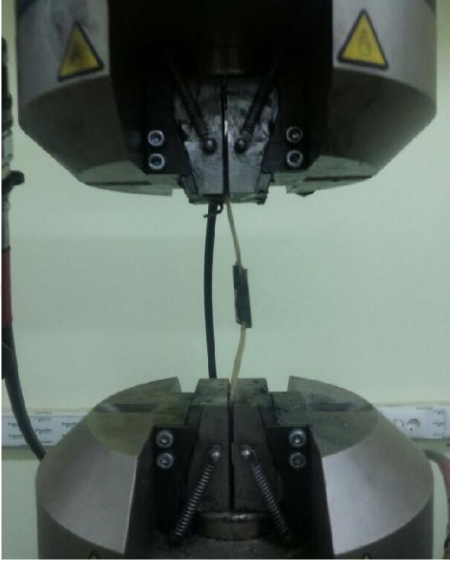
Şekil 5.6. Kritik burkulma yükünü geçtikten sonra burkulan malzeme
