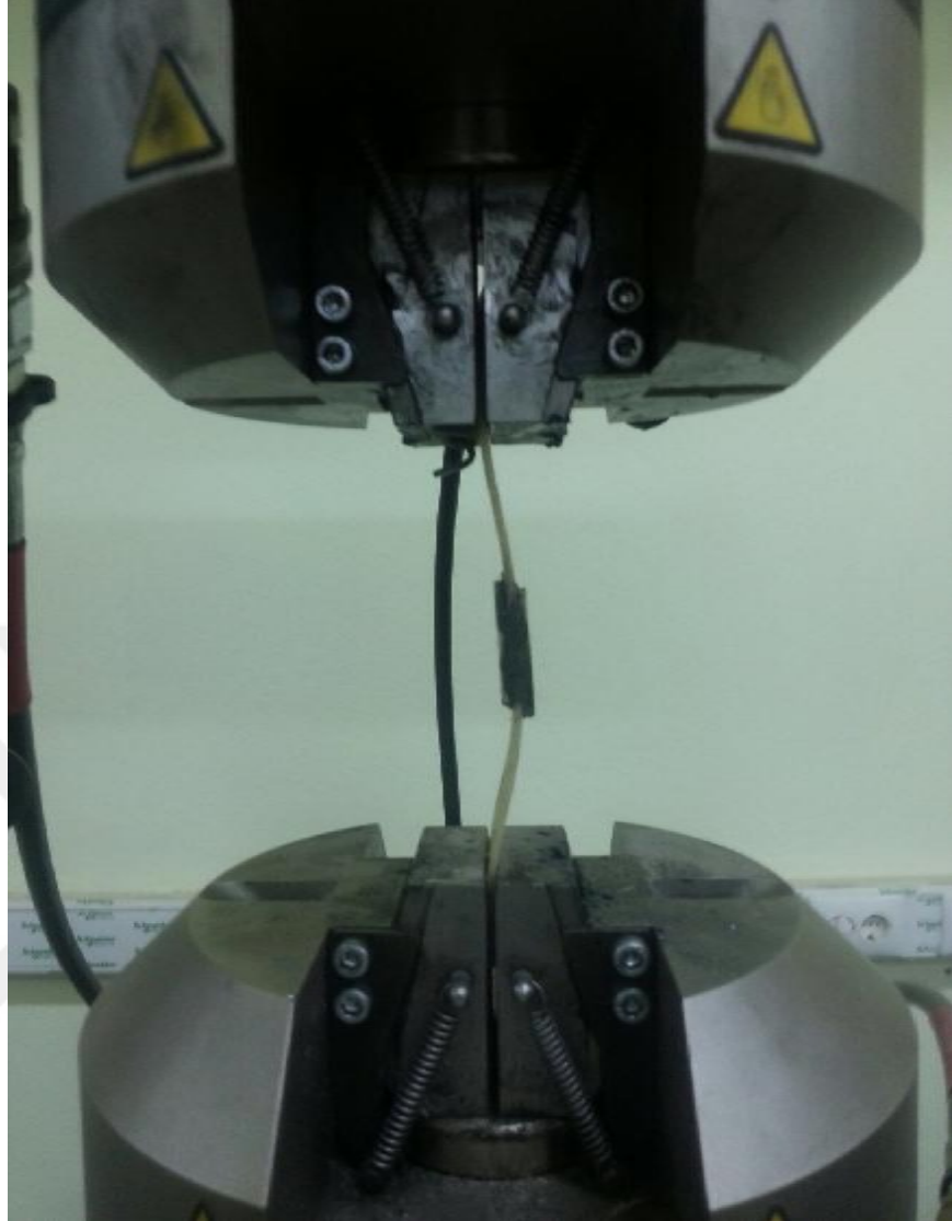
Şekil 5.8. Çift yüzünden yapıştırıcı ile yapıştırılmış numunenin kritik burkulma yükünü geçtikten sonra ki görünümü.
