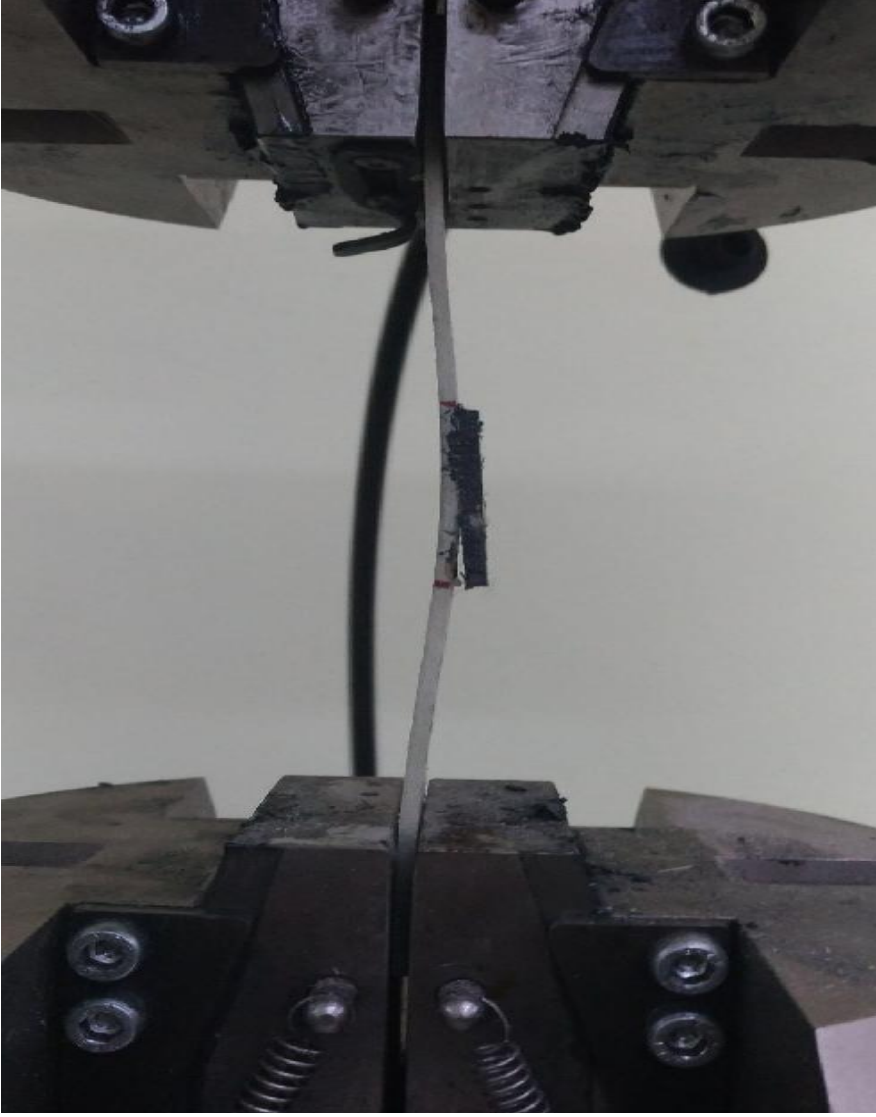
Şekil 5.7. Tek tarafından yapıştırıcı ile tamir edilmiş deney numunesinin deney sonrası yamanın yapıştırıcı kısmından ayrılması.
