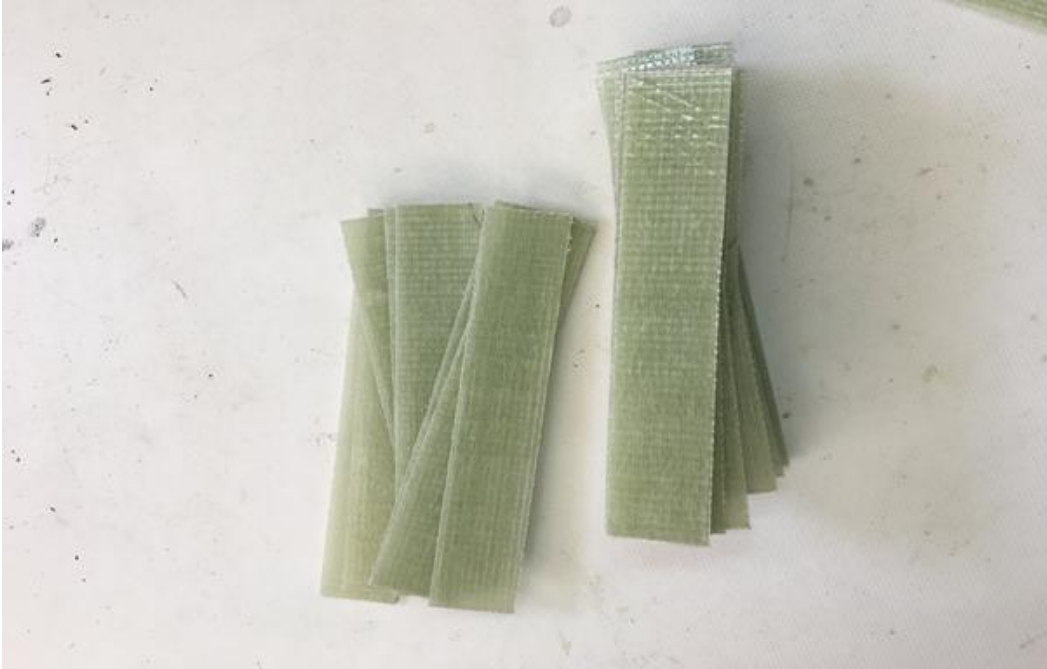
Şekil 4.3. İstenilen ölçülere göre kesilmiş numuneler
