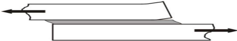
Şekil 3.22. Yapışkan (Yapışma çizgisi) Kırılma-Soyma (Yarrington ve ark., 2005)
