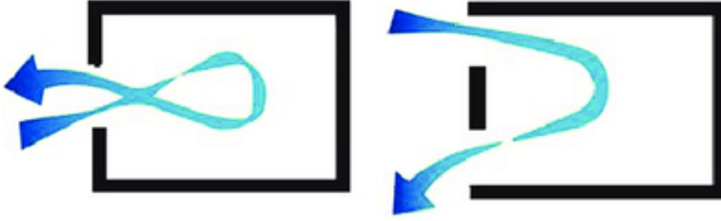
Şekil 2.30. Tek Taraflı Havalandırma - Şematik Plan (Marzban ve Ark. 2016:583)
