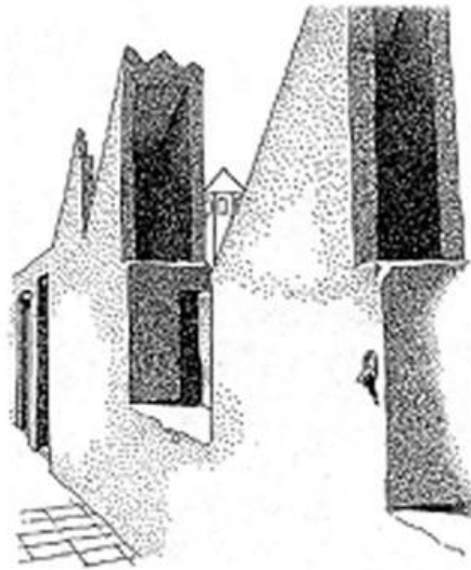
Şekil 2.86. Irak'ta Bulunan Duvara Paralel Badgirler (Ragette 2003:87-90)
