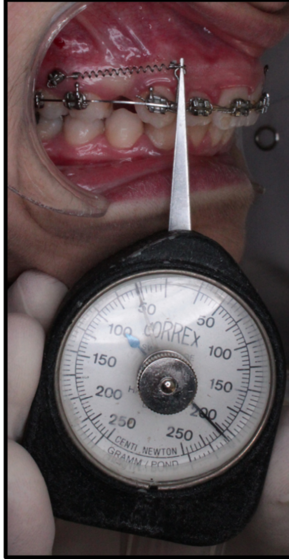
Şekil 9: Power Hook grubundaki Ni-Ti kapayıcı sarmal yayın aktif halde iken uyguladığı kuvvetin tespit edilmesi.
