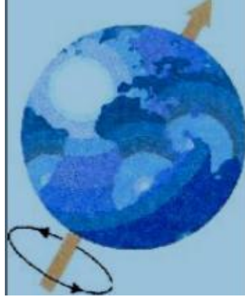
Şekil 2. Pozitif yüklü protonlar kendi eksenleri etrafında dönerler ve kendi manyetik alanlarını oluştururlar
