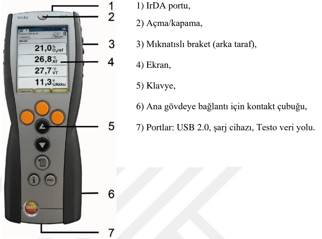
Şekil 3.7. Testo 350 kontrol ünitesi
