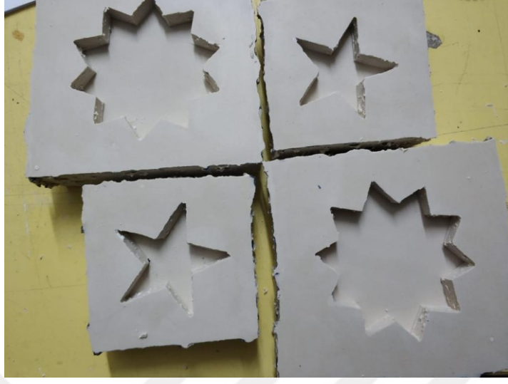
Güneşin ışıkları katmanlı çini, katmanlar için alçı kalıp çalışması.
