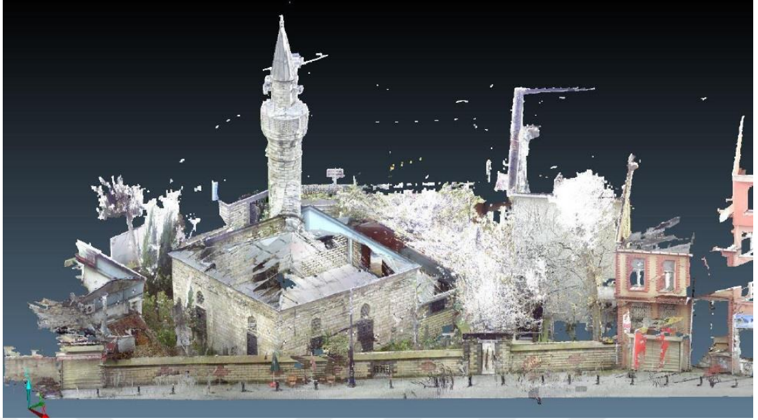
Şekil 1 Yüksek çözünürlüklü fotoğraflarla renklendirilmiş 2d noktabulutunu modelinden elde edilen 3b nokta bulutu modeli. (Ekim 2018).
