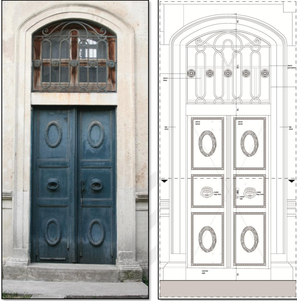
Şekil 135: Giriş Kapısı - Restorasyon Projesindeki Bütünlemeler
