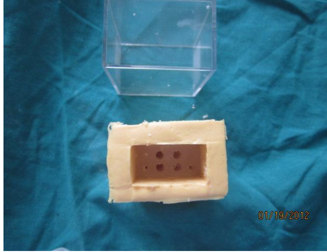
Resim 26: Akrilik kalıp elde etmek iin hazırlanan dzenek
