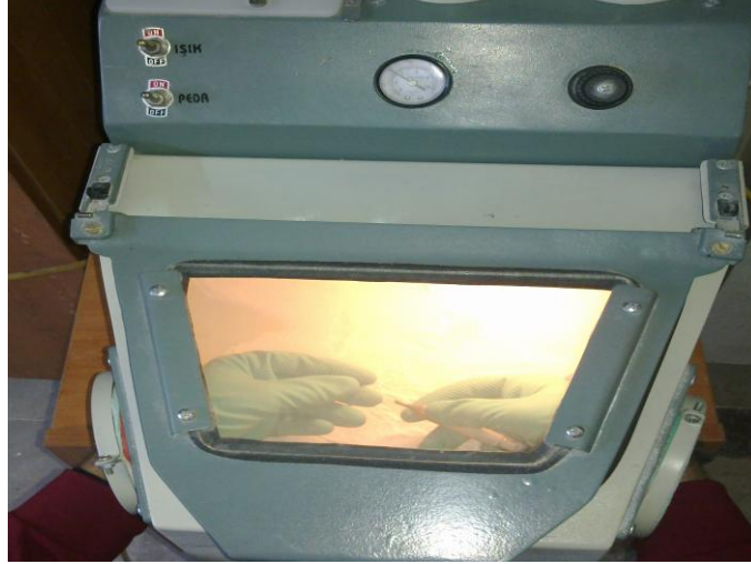
Resim 22: Al 2 O 3 ile kumlama
