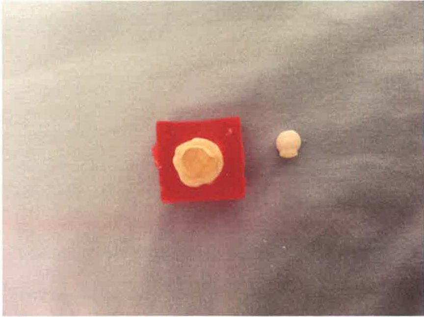
Resim 38: Resin simanın yarısından fazlasının dentin yüzeyinde olan örneğin görüntüsü
