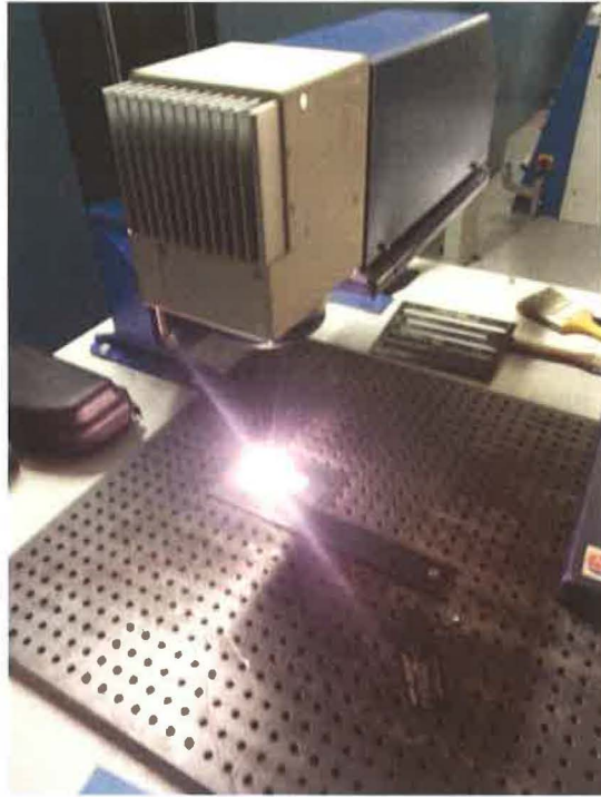
Resim 24: Fiber lazerin zirkonyum diske uygulanması
