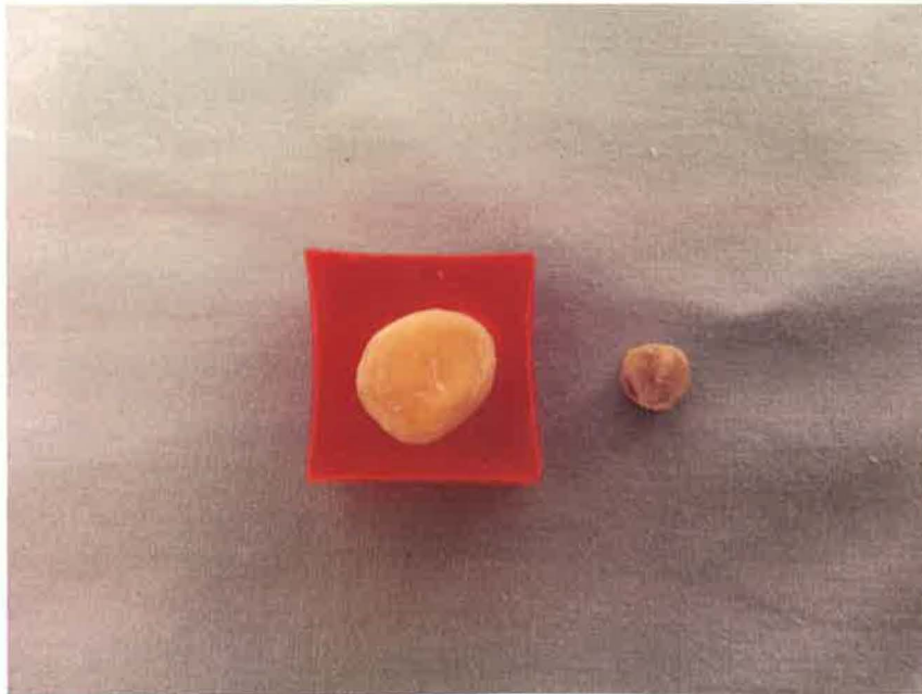
Resim 36: Rezin simanın tamamının zirkonyum yüzeyinde olan örneğin görüntüsü
