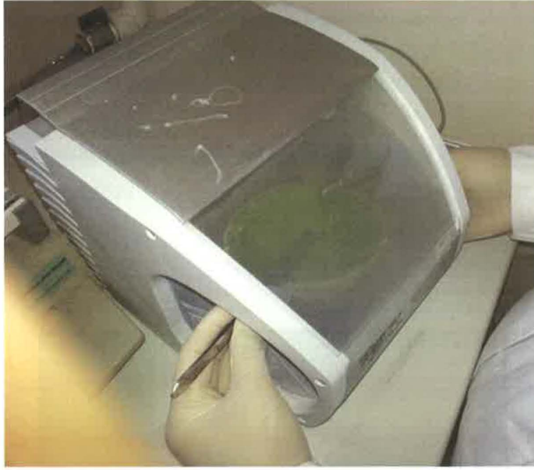
Resim 15: Zirkonyum disklerin silika kaplı Al_2O_3 ile kumlanması
