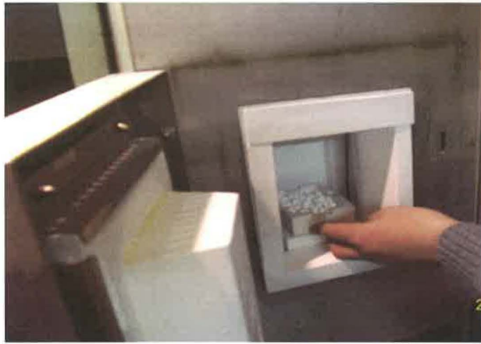
Resim 11: Zirkonyum disklerin sinterleme için fırına yerleştirilmesi
