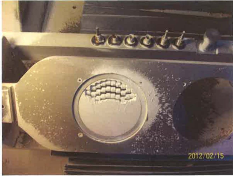
Resim 9: Zirkonyum disklerin freze teknolojisi ile üretimi
