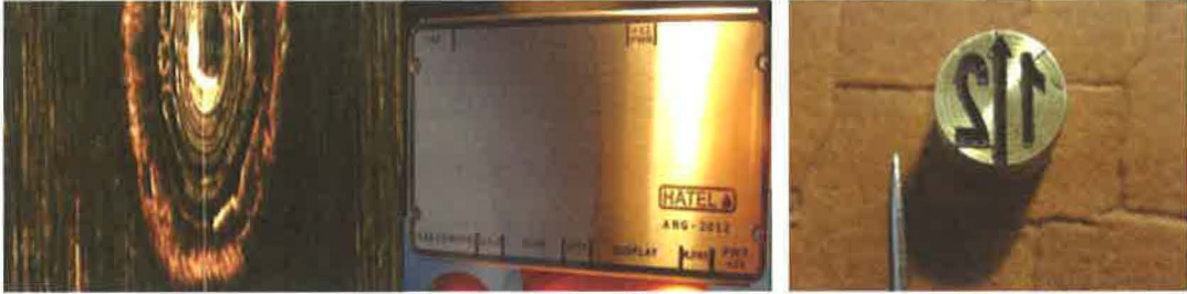
Resim 2: Yb:Fiber lazer ile kaynak yapılmış, yazı yazılmış ve oyma yapılmış örnekler
