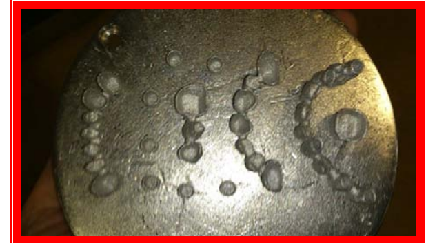
Resim 22. Lazer Sinter Co-Cr kopinglerin titantum plaka üzerindeki görünümü
