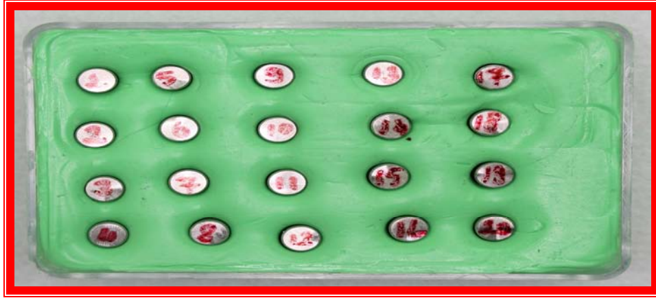
Resim 5. Paslanmaz çelik day Modeller özel olarak hazırlanmış kalıp içerisinde
