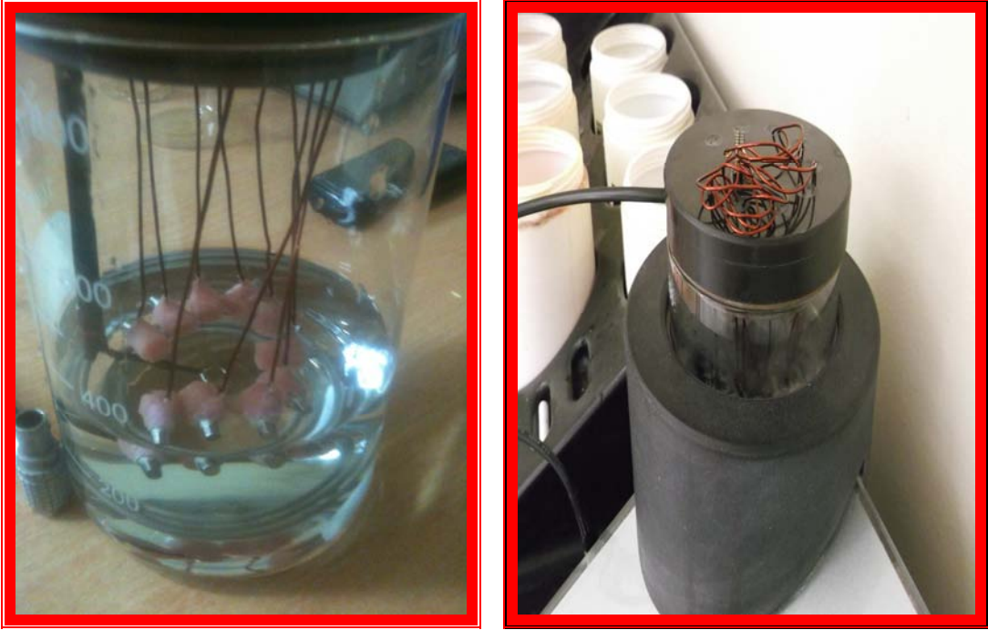
Resim 23. Elektrokaplama işlemi için Lazer sinter Co-Cr kopinglerin cihazın yükleme kafasına yerleştirilmesi
