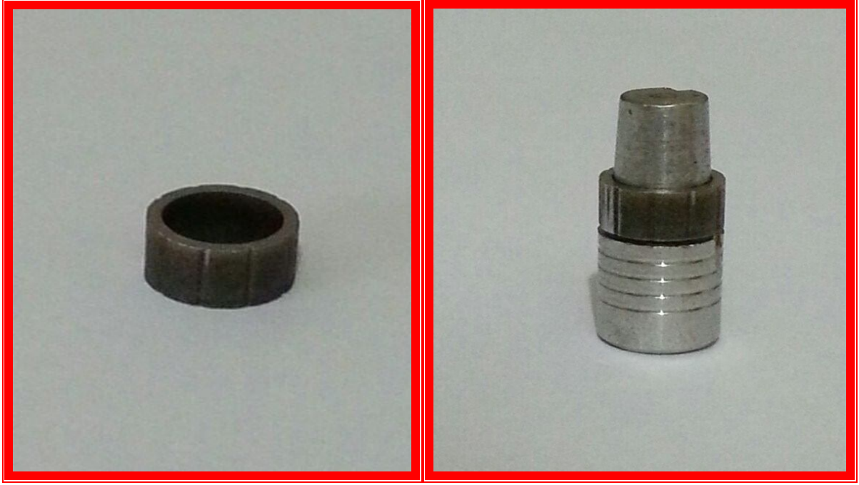
Resim 3. Bıçak sırtı marjinal sonlanma şekline sahip daylar üzerinde ölçümleri gerçekleştirmek için elde edilen çelik halka
