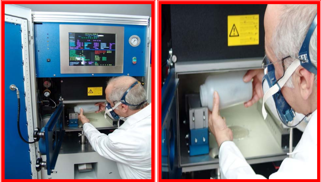
Resim 18. Co-Cr Toz metalin serici bölüme doldurulması işlemi
