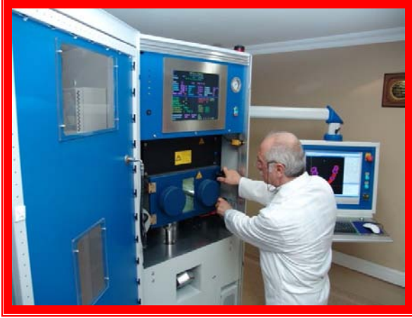
Resim 19. Sızdırmaz kabin kapağının kapatılıp makinenin işlem için hazır duruma getirilmesi
