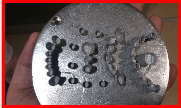
Resim 22. Lazer Sinter Co-Cr kopinglerin titantum plaka üzerindeki görünümü
