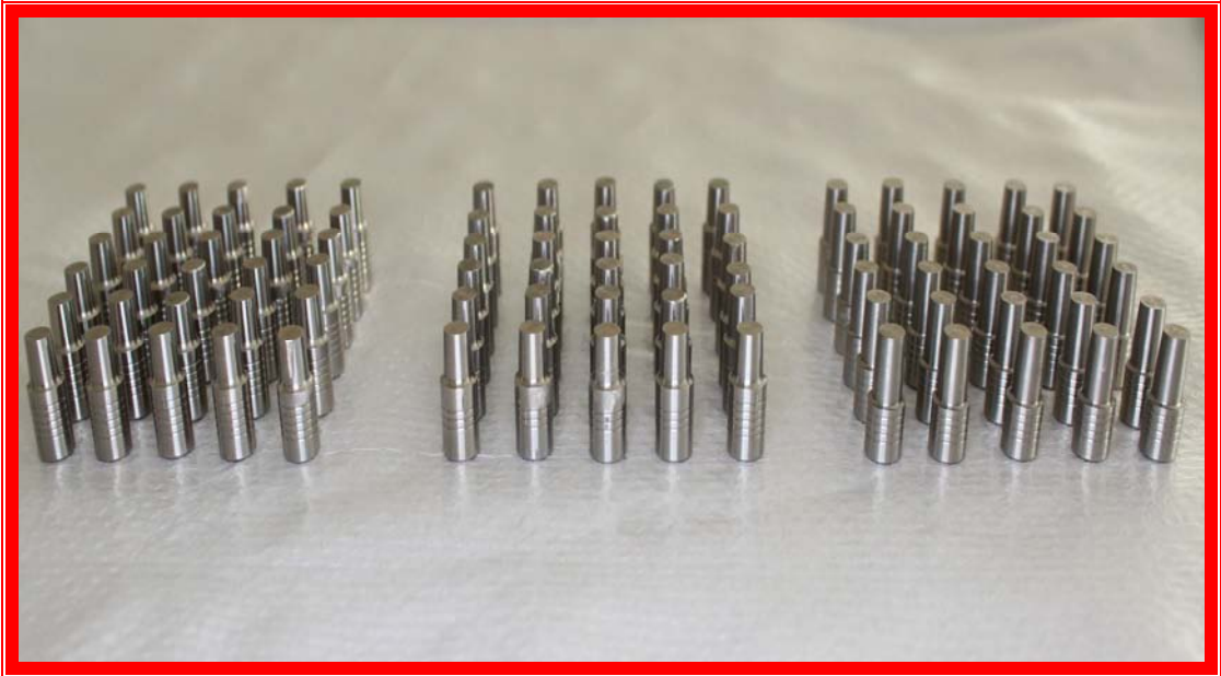
Resim 4. Çalışmamızda kullandığımız paslanmaz çelik daylar
