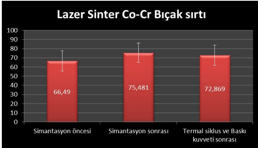
Grafik 6. Bıçak sırtı basamak preparasyonuna sahip lazer sinter Co-Cr kopinglerin simantasyon öncesi, sonrası ve Termal siklus ve Baskı kuvveti işlemleri sonrası ortalama marjinal aralık ölçüm değerleri
