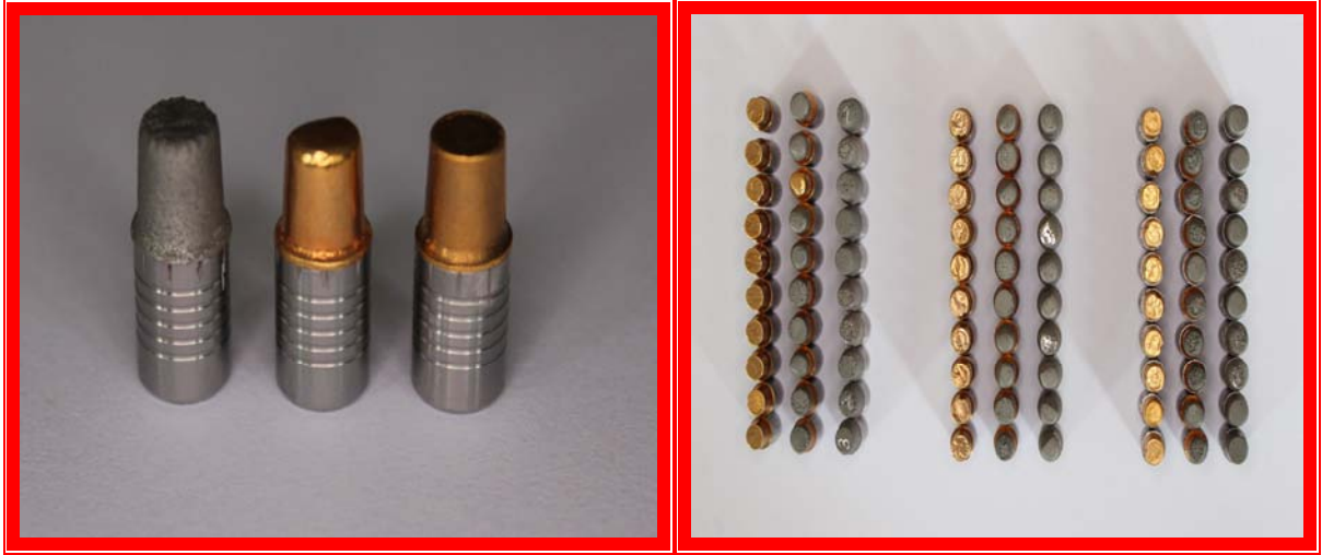
Resim 24. Elde edilen Galvano kopingler, Lazer sinter Co-Cr kopingler ve Lazer sinter Co-Cr üzeri altın kaplı kopingler
