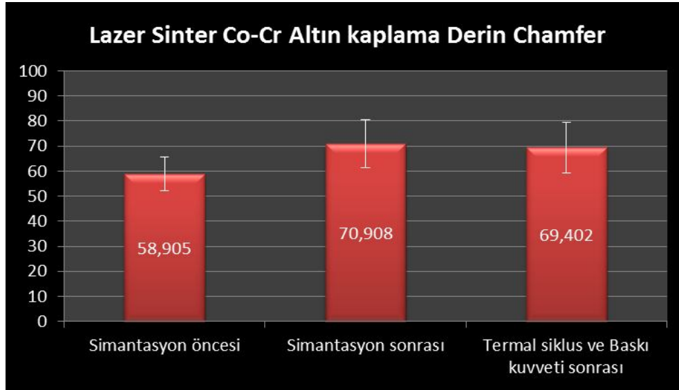
Grafik 8. Derin Chamfer basamak preparasyonuna sahip lazer sinter Co-Cr üzeri altın kaplama kopinglerin simantasyon öncesi, sonrası ve Termal siklus ve Baskı kuvveti işlemleri sonrası ortalama marjinal aralık ölçüm değerleri
