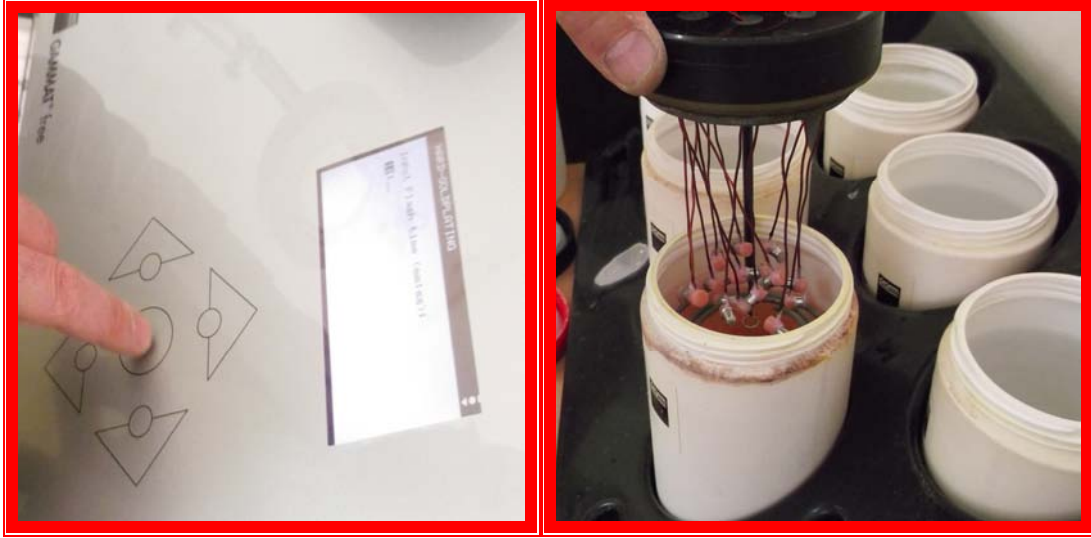
Resim 8. Cihazın elektroşekillendirme işlemi için ayarlanması ve dayların cihazın yükleme kafasına yerleştirilmesi
