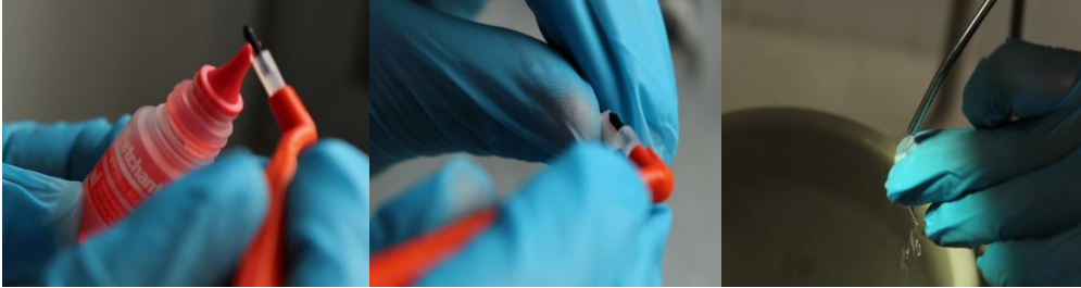
Resim 20:Tam seramik yüzeyine K-etchant jel uygulanması
