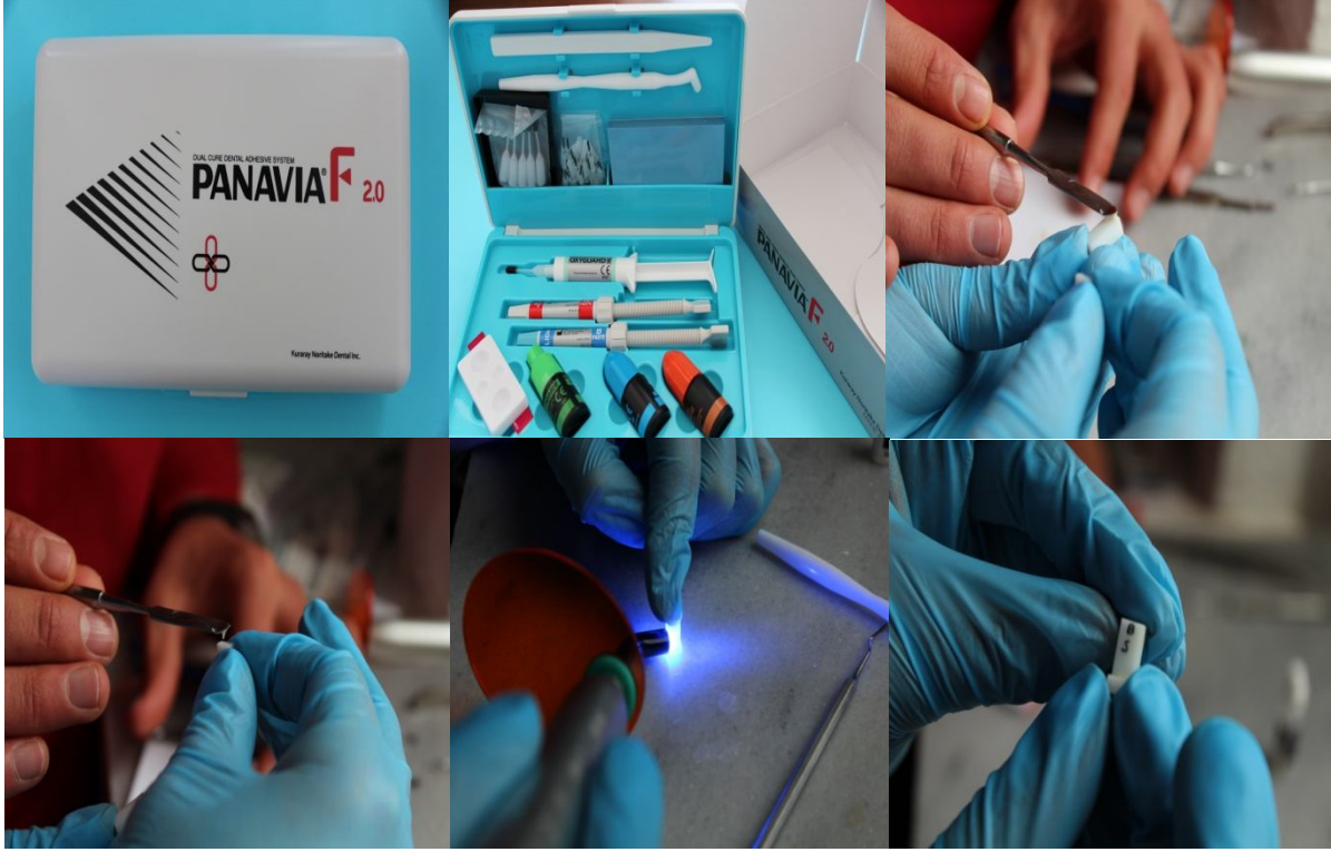
Resim 12: Zirkonya örneğin yüzeyine tam seramik örneğin simantasyonu
