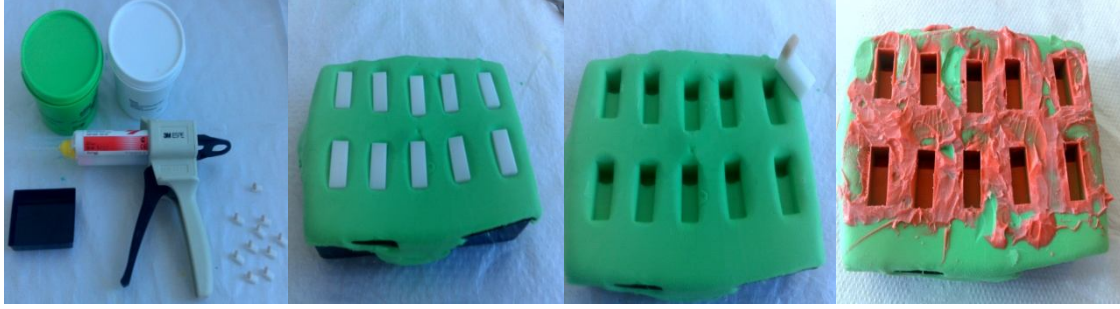
Resim 4: Zirkonya-seramik örneklerden ölçü alınması işlemi
