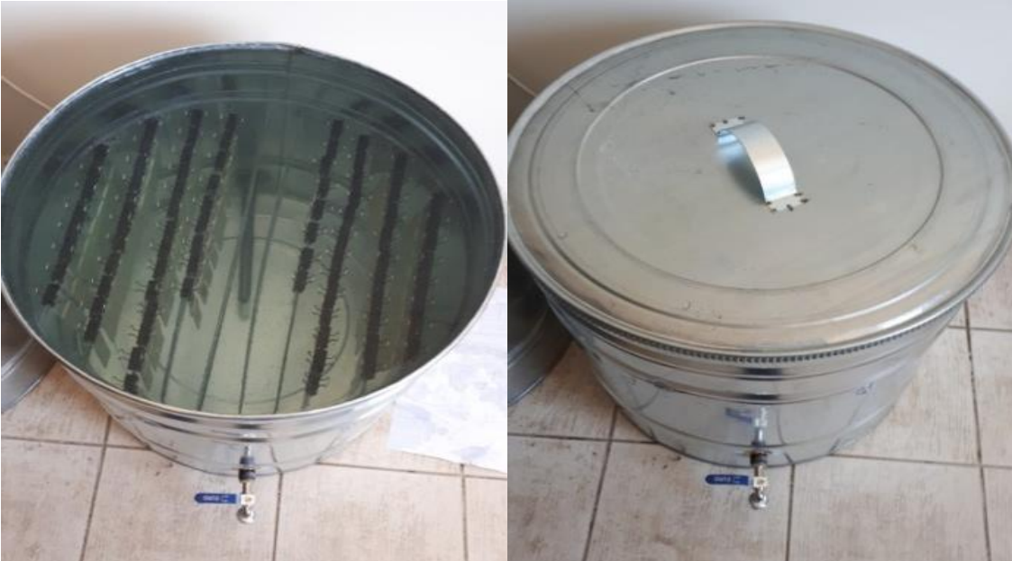
Şekil 3.19. Kompozit numunelerin termostatlı sıcak su kazanına yerleştirilmesi
