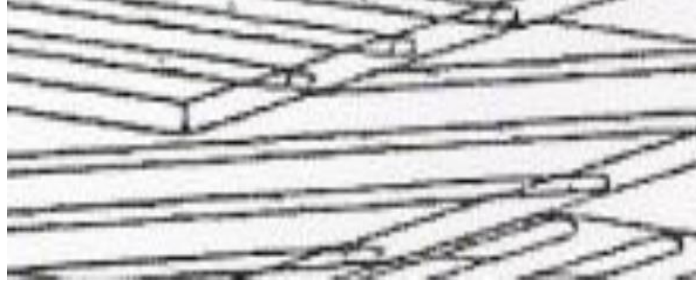
Şekil 3.1. Açılı tabakalı kompozitlerin gösterimi (Sayman, 2007)
