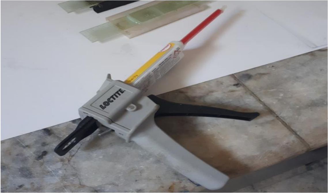
Şekil 3.16. Yapıştırma işlemi için kullanılan özel tabanca ve Loctite Hysol-9466 epoksi esaslı yapıştırıcı
