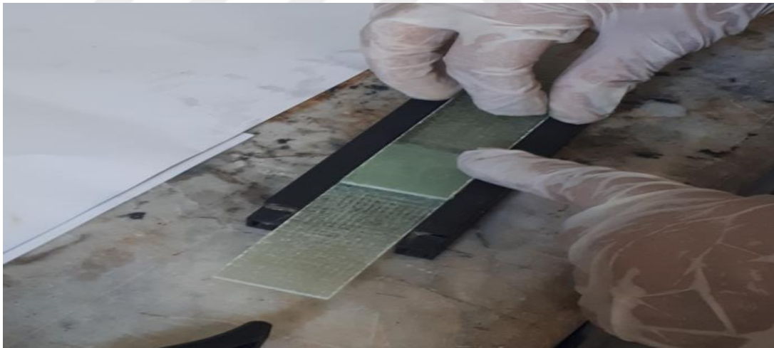
Şekil 3.17. Yapıştırıcı sürüldükten sonra numunenin kalıba yerleştirilmesi
