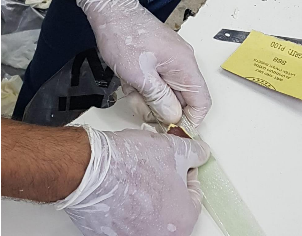
Şekil 3.13. Deney için kullanılan levhaların yüzey zımparalama ve yüzey temizleme işlemi
