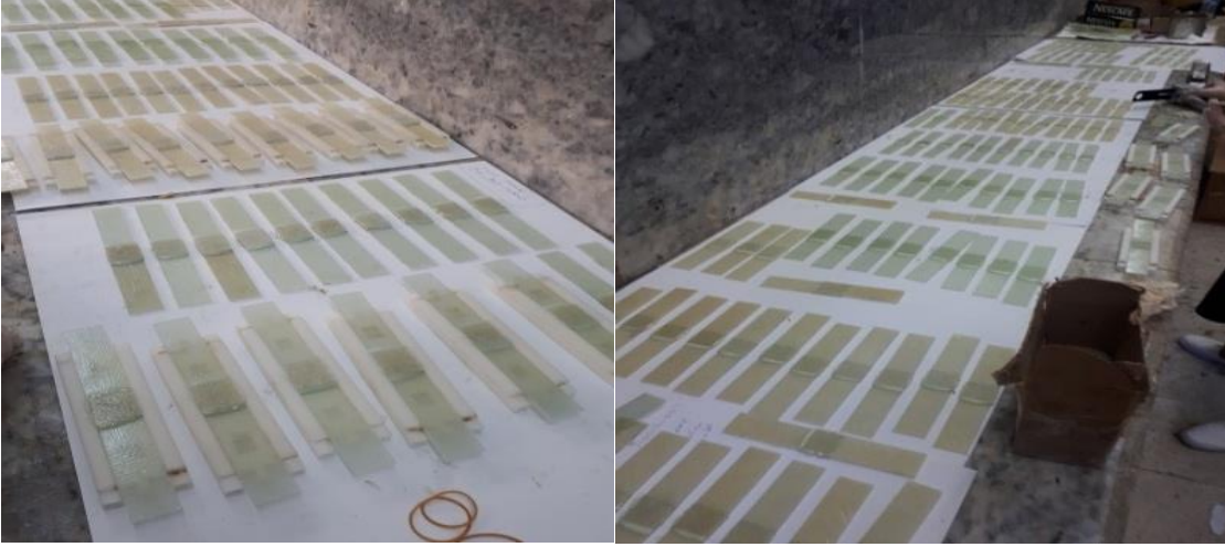
Şekil 3.18. Yapıştırma işlemi ve kurumaya bekletilen numuneler
