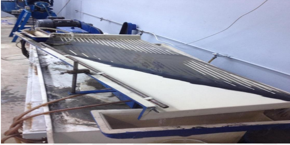
Şekil 3.2. Çalışmada kullanılan sallantılı masa ayarımı yaparken
