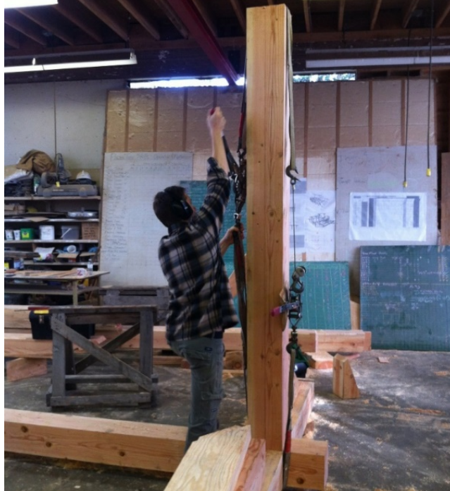
řekil 3.12: Palanga ile bileřenlerin sıkıřtırılması.
