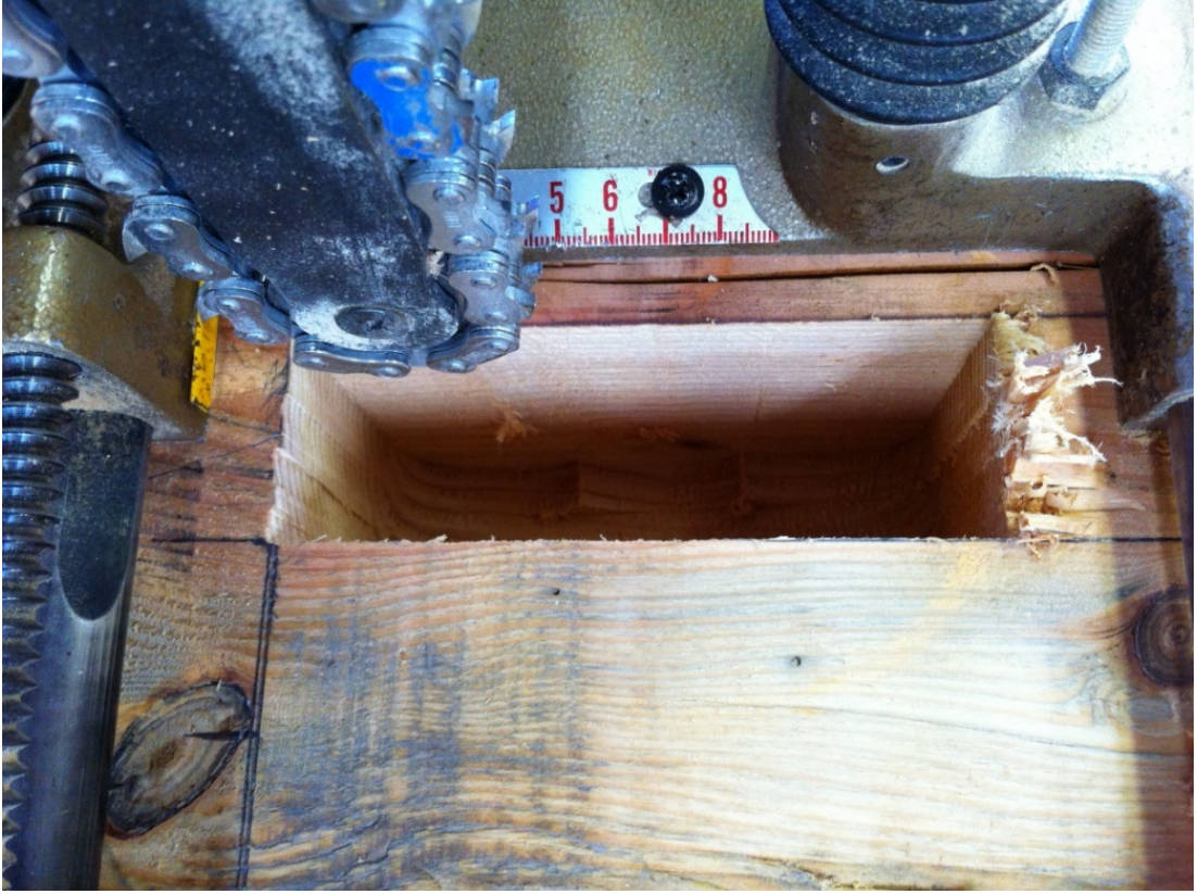
Şekil 4.9: Zıvananın kesim çizgilerine göre açılması.
