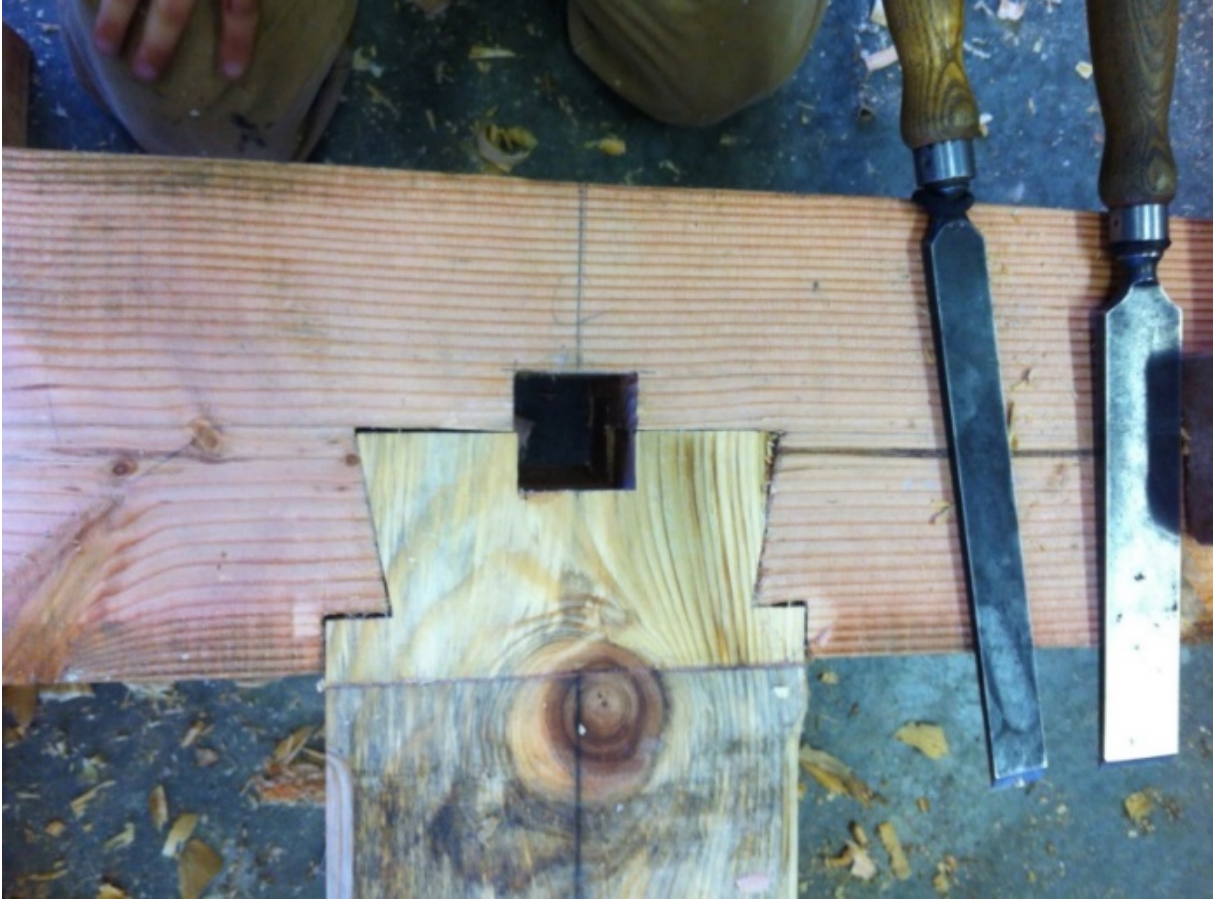
řekil 2.15: Gűđslű kırlanđıç kuyruđu geme.
