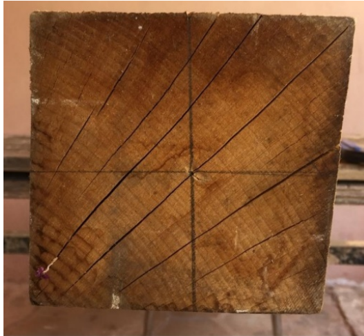
Şekil 3.1: Hızar kesiminin merkez hattına göre yamukluğu.
