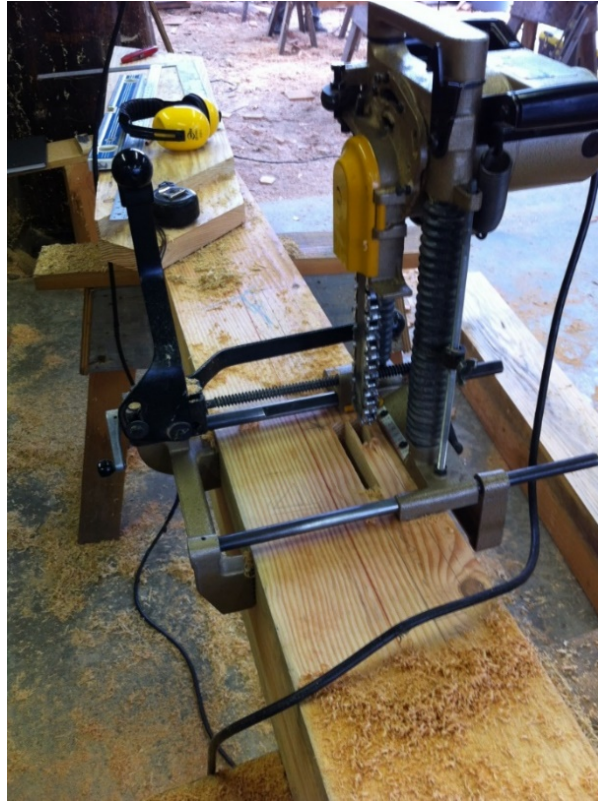
Şekil 3.10: Kiriş üzerinde zıvana açılması için zincirli matkap kullanımı.
