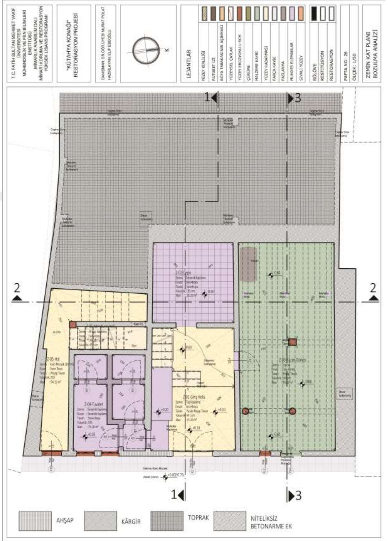
Çizim 26. Rölöve; Zemin Kat Planı Bozulma Analizi
