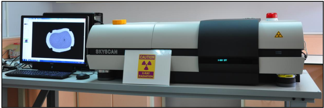
Şekil 3.5: Çalışmada taramalar için kullanılan Skyscan 1172 Mikro-BT sistemi
