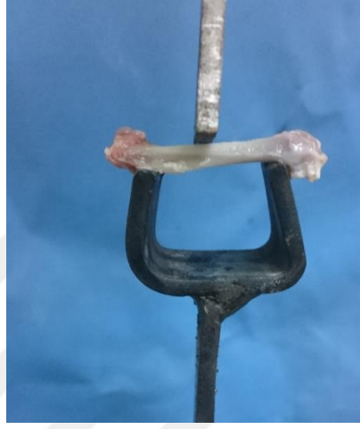
Şekil 14. Kırma testi için cihaza yerleştirilmiş rat femuru
