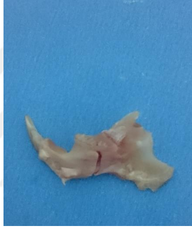
Şekil 17. Deney sonrası kırılmış mandibula (kırık hattı izlenmektedir)
