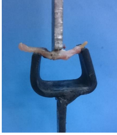
Şekil 16. Kırma testi için cihaza yerleştirilmiş sağ rat mandibulası
