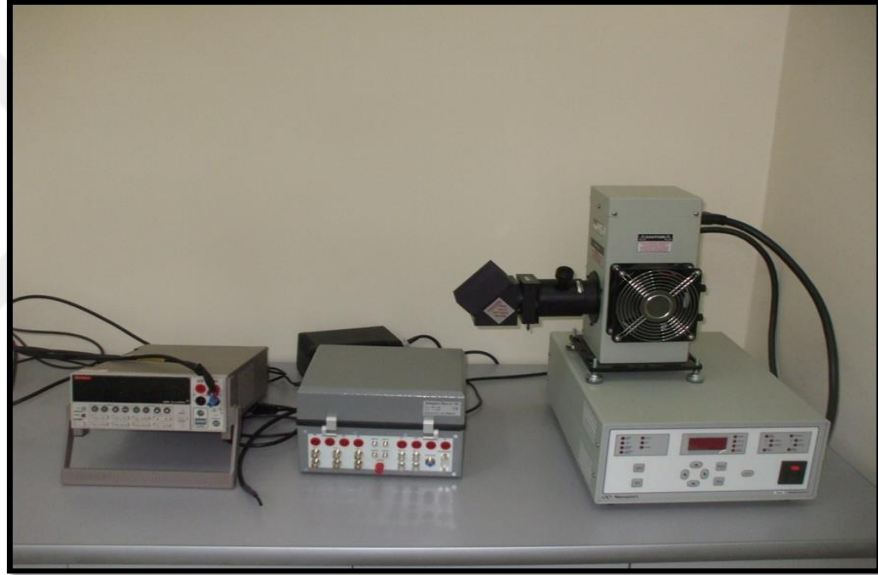
Şekil 3.16. Oriel marka güneş simülatörü içeren akım-gerilim ölçüm sistemi
