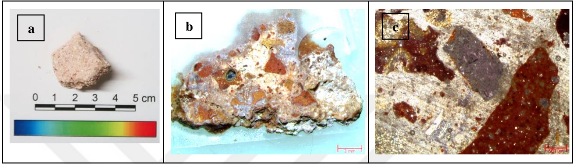
Şekil B.2: 2 nolu örnek; a) Genel görünüş, b) Stereo, c) Polarizan mikroskop
