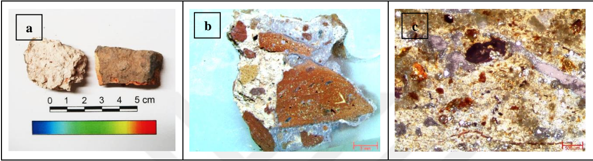
Şekil B.14: 14 nolu örnek; a) Genel görünüş, b) Stereo, c) Polarizan mikroskop
