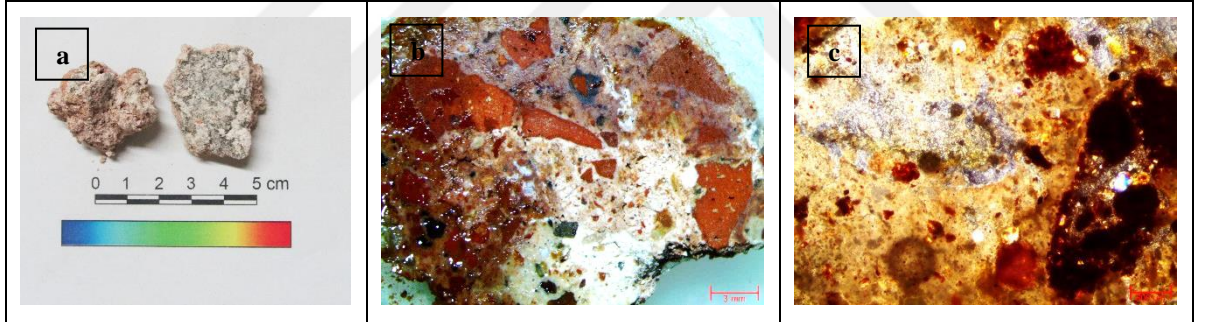
Şekil B.27: 27 nolu örnek; a) Genel görünüş, b) Stereo, c) Polarizan mikroskop
