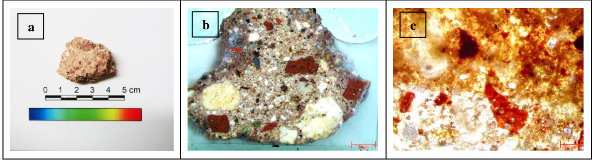
Şekil B.33: 33 nolu örnek; a) Genel görünüş, b) Stereo, c) Polarizan mikroskop
