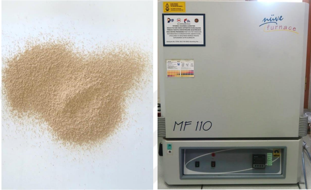
Şekil 3.2: Toz haline getirilmiş numune ve kül fırını (KURAM Laboratuvarı)
