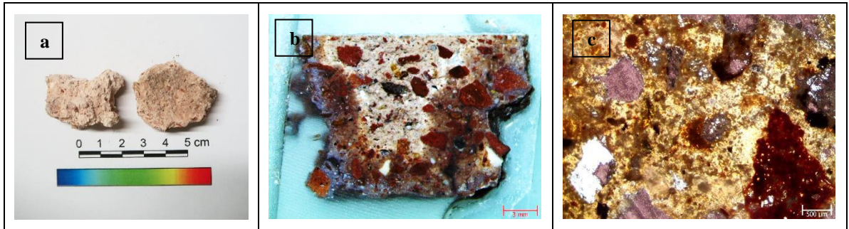
Şekil B.36: 36 nolu örnek; a) Genel görünüş, b) Stereo, c) Polarizan mikroskop
