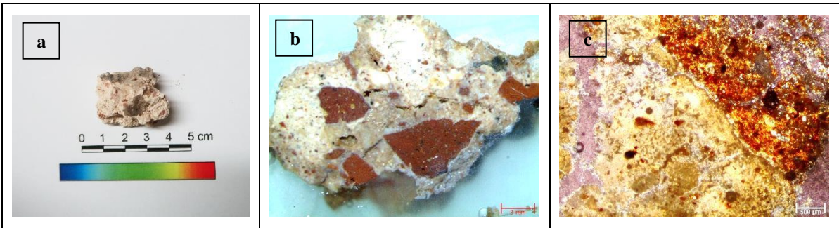
Şekil B.16: 16 nolu örnek; a) Genel görünüş, b) Stereo, c) Polarizan mikroskop
