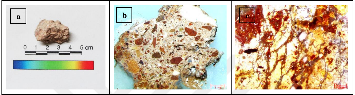
Şekil B.26: 26 nolu örnek; a) Genel görünüş, b) Stereo, c) Polarizan mikroskop
