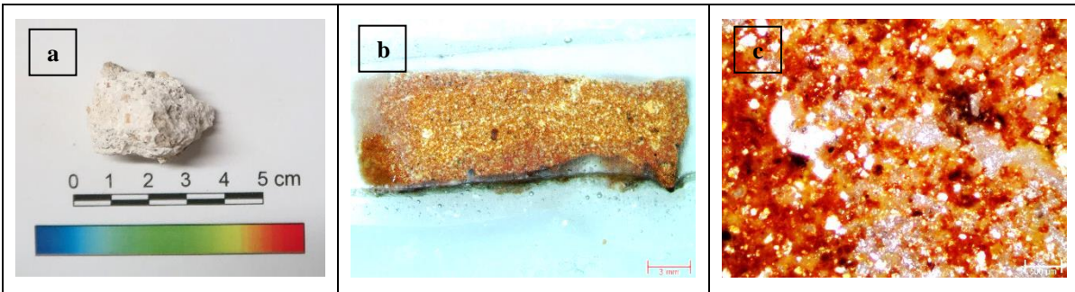
Şekil B.8: 8 nolu örnek ait; a) Genel görünüş, b) Stereo, c) Polarizan mikroskop
