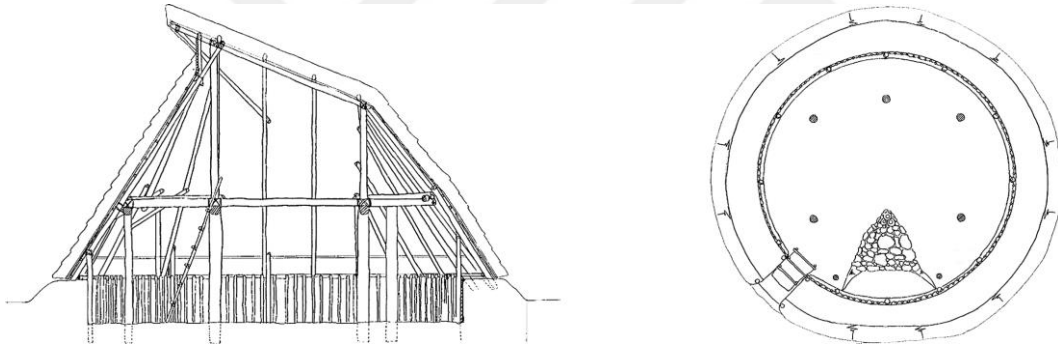
Şekil 4.1 Tateana-shiki jukyo plan ve kesiti (URL-10)
