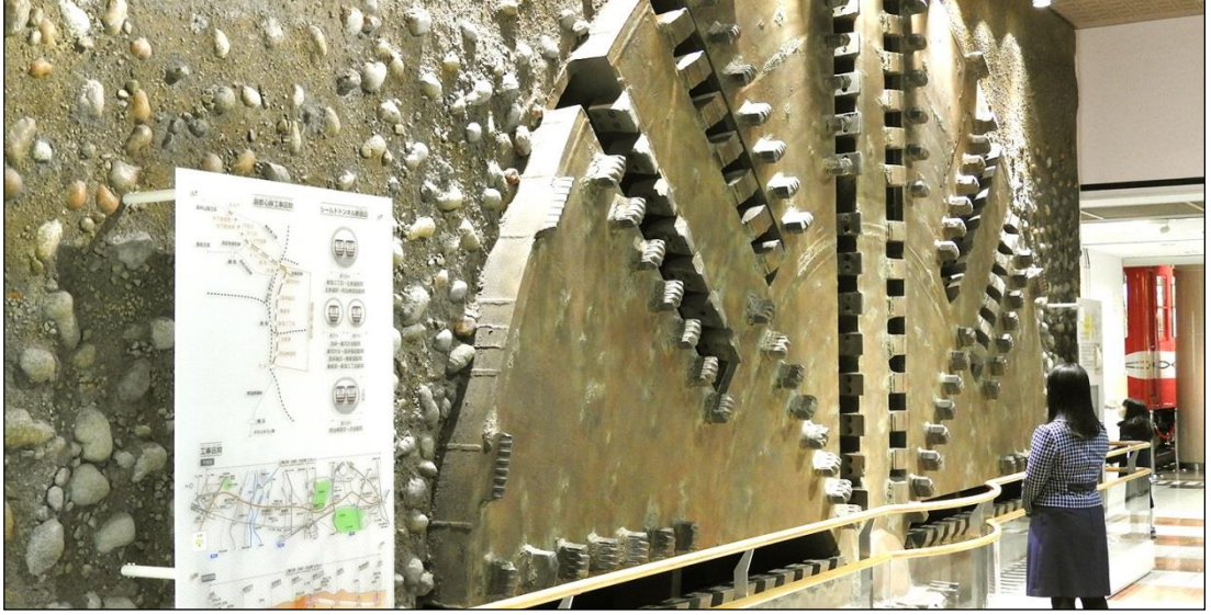
Şekil 46: Tünel Açma Makinesi (TBM) Başlığı (Url-31).
