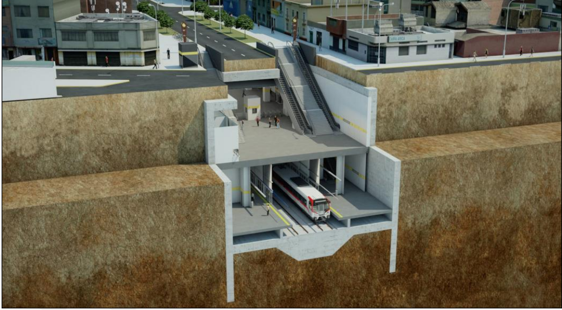
Şekil 14: Aç-Kapa Yapım Yöntemi (Url-8).
