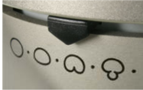
Şekil 29 - Çok yönlü (Multi-Directional) bir mikrofonda desen değıştirme anahtarı
