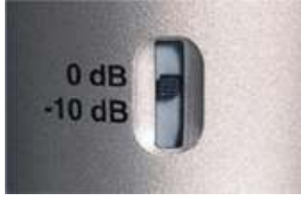
Şekil 31 - Mikrofon üzerinde “Pad” anahtarı
