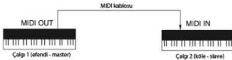
Şekil 33 – Basit MIDI bağlantısı (Rumsey, 2004'den değiştirilerek)
