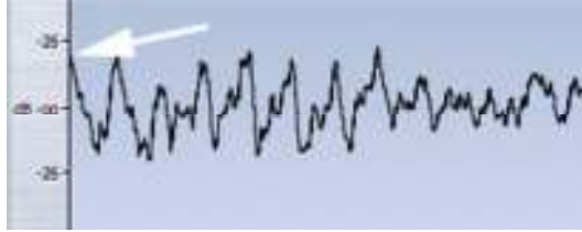
Şekil 61 – Zero-Crossing bölgesi dışında kesilmiş örnek
