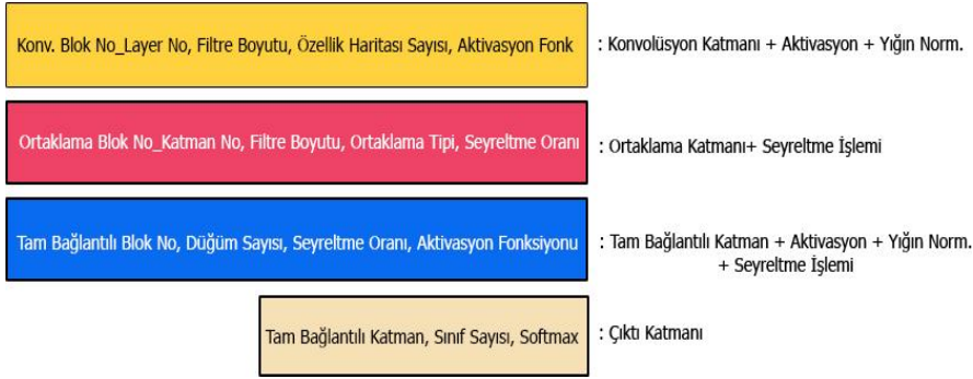
Şekil 5.19: En iyi KSA topolojilerinin anlatılması için kullanılan notasyon
