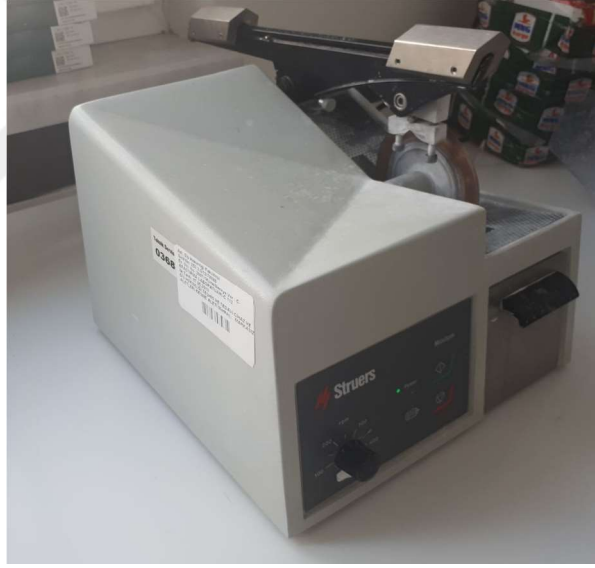
Resim 6. Minitom (Hassas kesme cihazı) ile örneklerin kesilmesi
