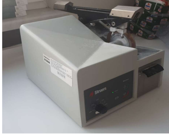
Resim 9. Minitom (Hassas kesme cihazı) ile örneklerin kesilmesi
