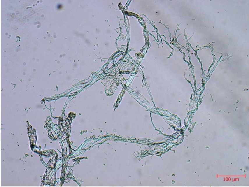
Resim 4.22. Fatih 2810'dan alınan kâğıt örneğine ait lif numunesinde floroglusinol testi sonucu renk değişimi, 200x büyütme
