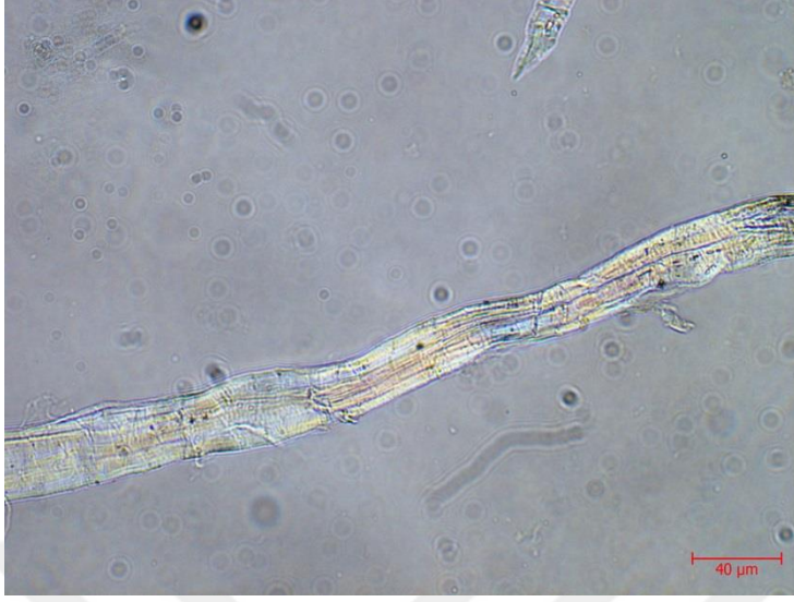
Resim 4.46. Yeni Cami 980'den alınan kâğıt örneğine ait lif-şişme (İng. swelling ) görüntüsü, 500x büyütme
