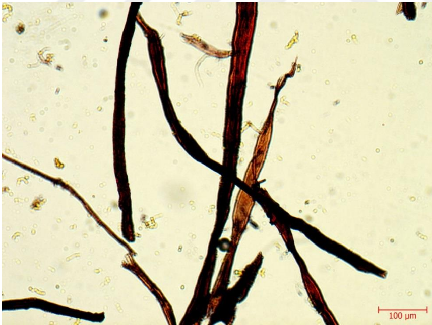
Resim 4.78. Şehid Ali Paşa 2391-001'den alınan kâğıt örneğine ait lif numunesinde floroglusinol testi sonucu renk değişimi, 200x büyütme
