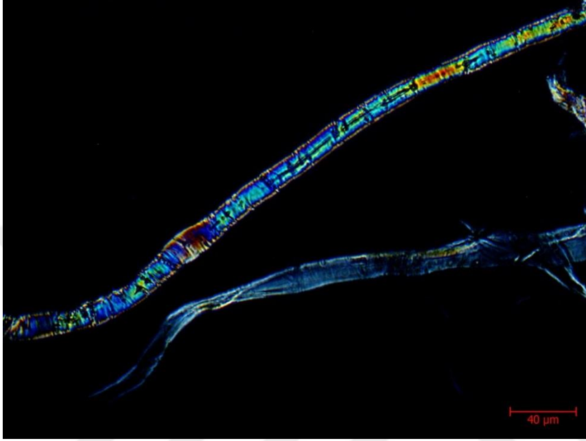
Resim 4.24. Fatih 2427'den alınan kâğıt örneğine ait bir lifin mikroskop görüntüsü, 500x büyütme, polarize ışık
