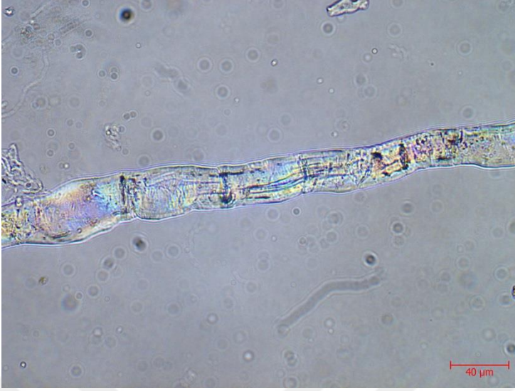
Resim 4.31. Murad Molla 576'dan alınan kâğıt örneğine ait lif-şişme (İng. swelling ) görüntüsü, 500x büyütme
