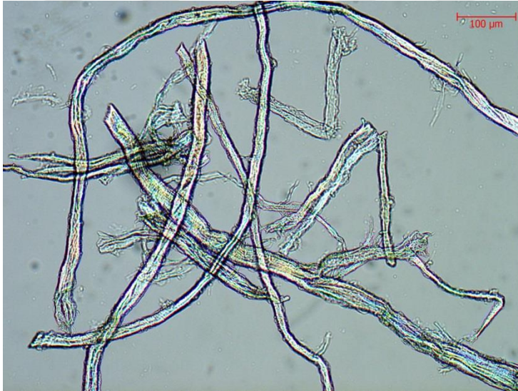
Resim 4.27. Fatih 2427'den alınan kâğıt örneğine ait lif numunesinde floroglucinol testi sonucu renk değişimi, 200x büyütme
