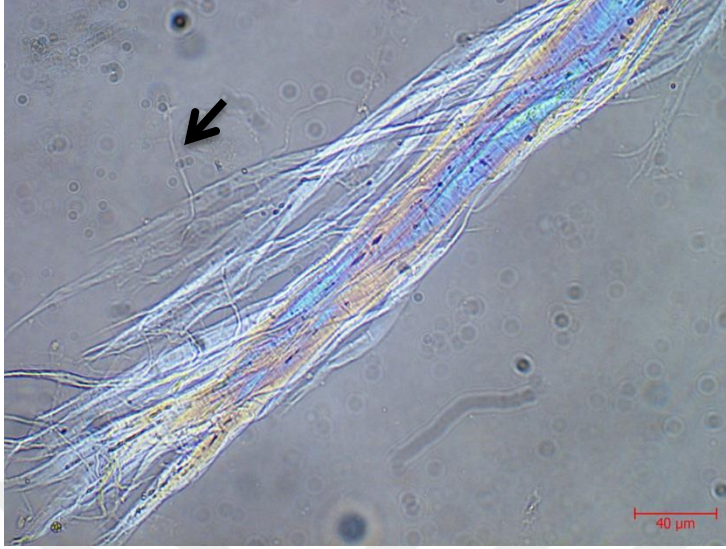
Resim 4.26. Fatih 2427'den alınan kâğıt örneğine ait lif demeti ve fibrilasyon görüntüsü, 500x büyütme
