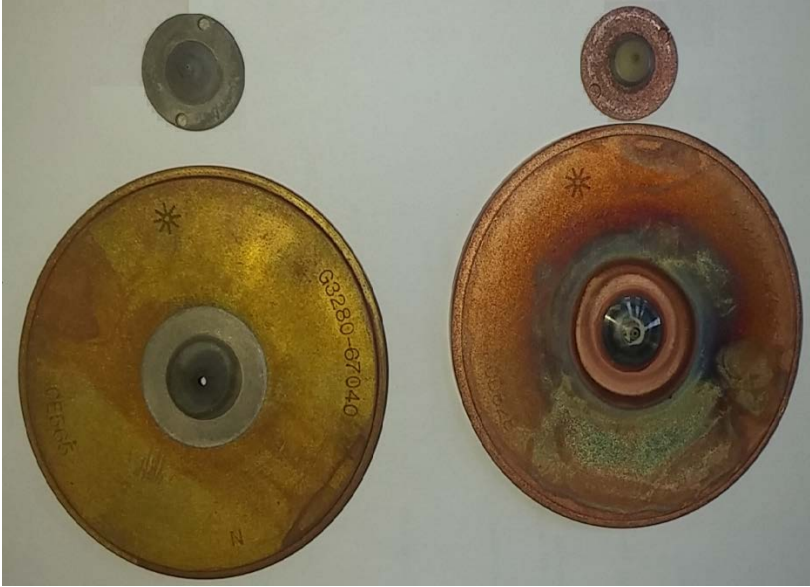
Resim 2. Sample ve Skimmer Cone uzun süre kullanımdan sonrası.
