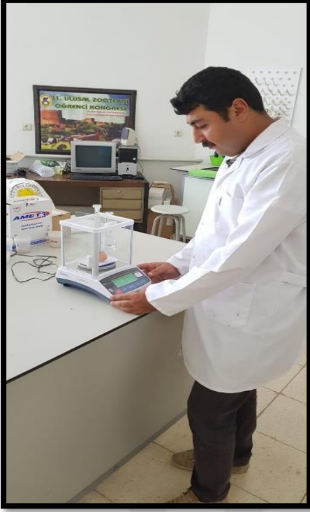
Şekil 3.8. Hassas Elektronik Terazi ile Yumurta Kabuğunun Ölçümü
