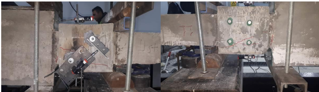
Şekil 4. 32. DS-R numunesinde oluşan ilk eğik çatlakları
