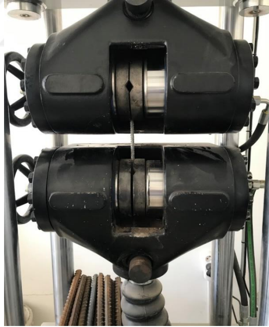
Şekil 3. 20. Enine donatı çekme deneyi
