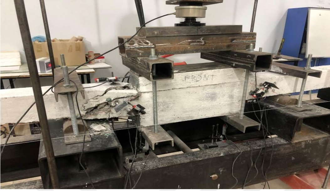
Şekil 4. 18. CCRS-O numunesinin deney sonlarına doğru hasar gelişimi
