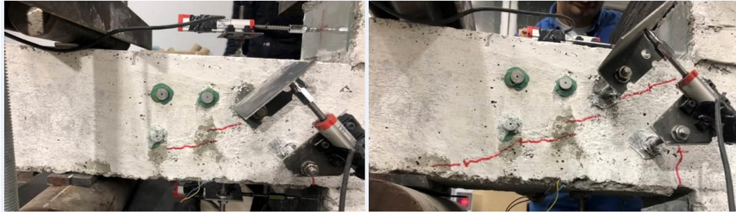
Şekil 4. 17. CCRS-O numunesinde oluşan ilk eğik kesme çatlakları
