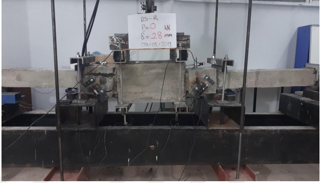
EK 3. 9. DS-R numunesi meydana gelen gcme Őekli (n yzden grnmm)
