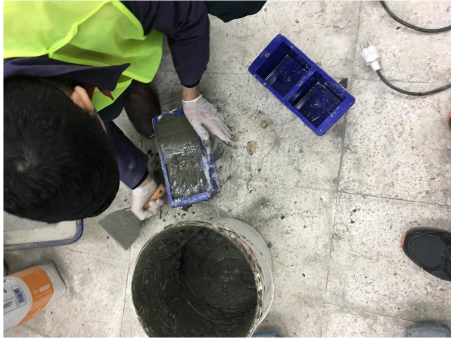
Őekil 3. 33. Standart kúp deney numuneleri için yapısal tamir harcından kúp numune alınması
