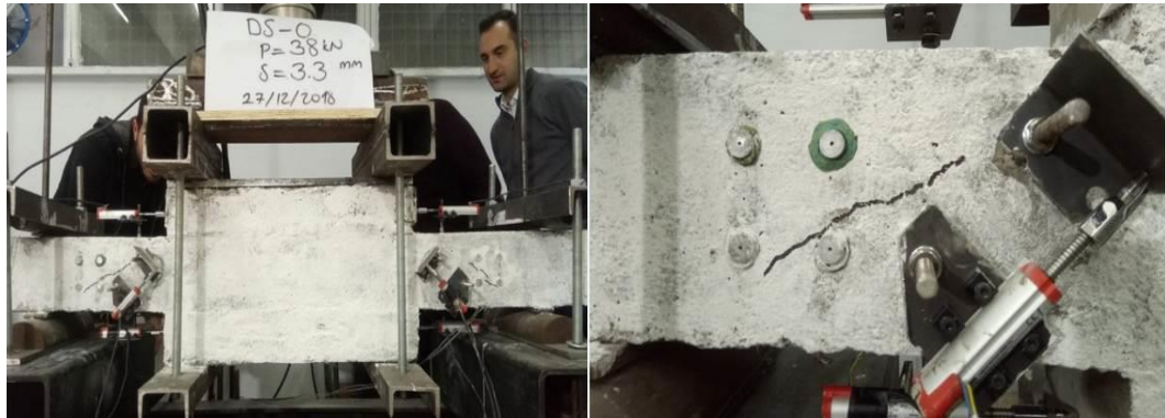
Şekil 4. 1. DS-O numunesinde oluşan ilk eğik çatlak
