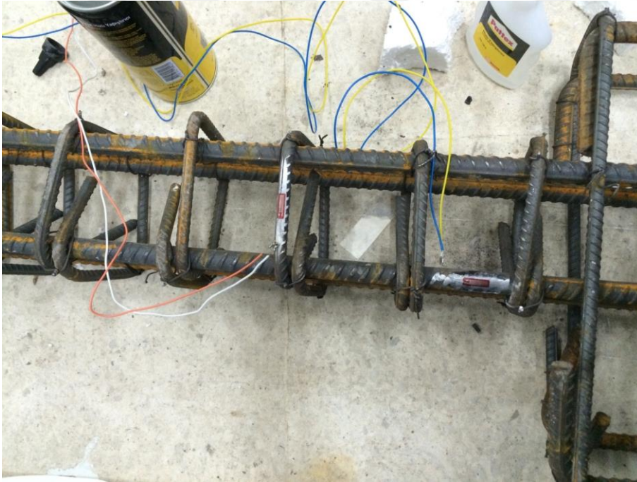
Şekil 3. 41. Donatı yüzeyine şekil değıştirme ölçerlerin yerleřtirilmesi
