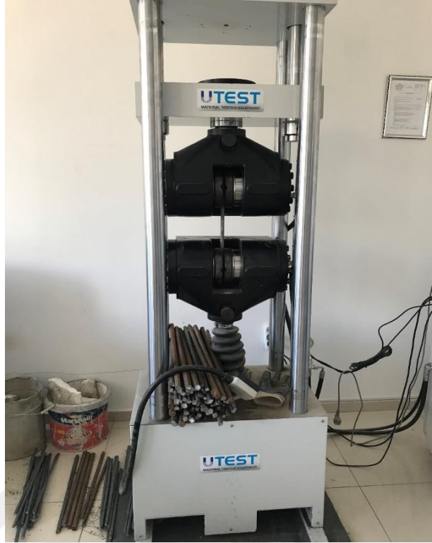
Şekil 3. 21. Boyuna donatı çekme deneyi
