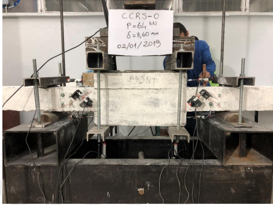
EK 3. 5. CCRS-O numunesi ön yüzde oluşan eğilme ve kesme çatlakları
