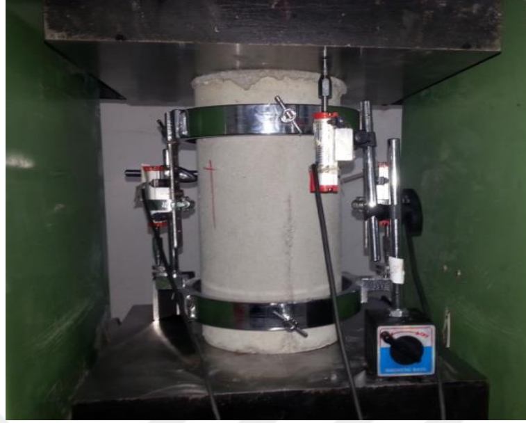
Şekil 3. 13. Standart silindir basınç deneyine ait düzenek
