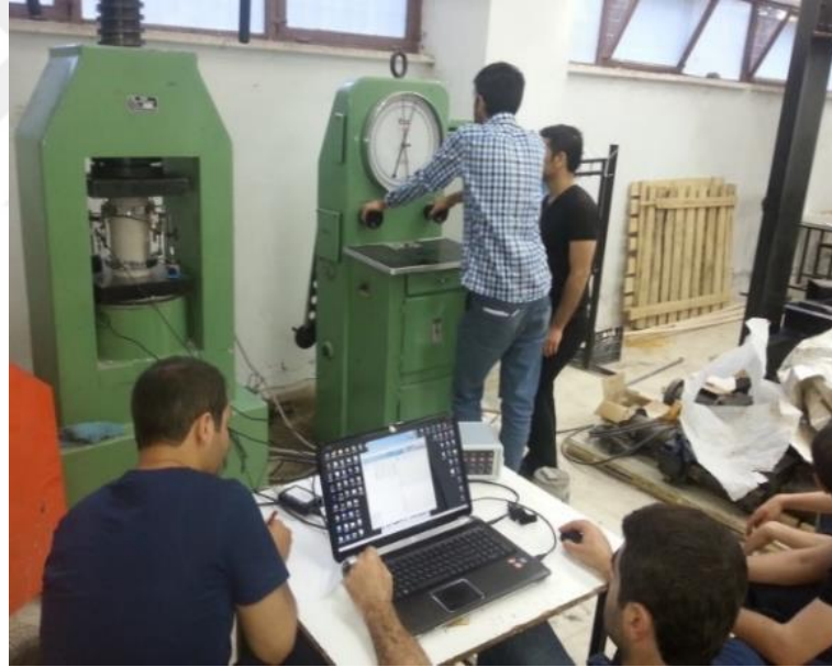
Şekil 3. 14. Standart silindir basınç deneyine ait düzenek
