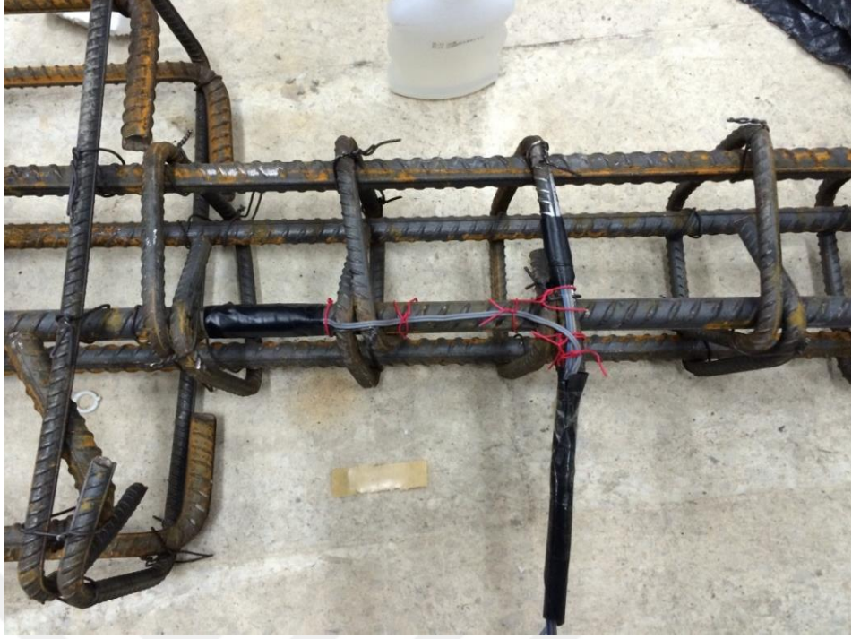
Őekil 3. 42. Donatı yzeyinde Őekil deęiŐtirme lerlerin koruyucu bant ile sargılması
