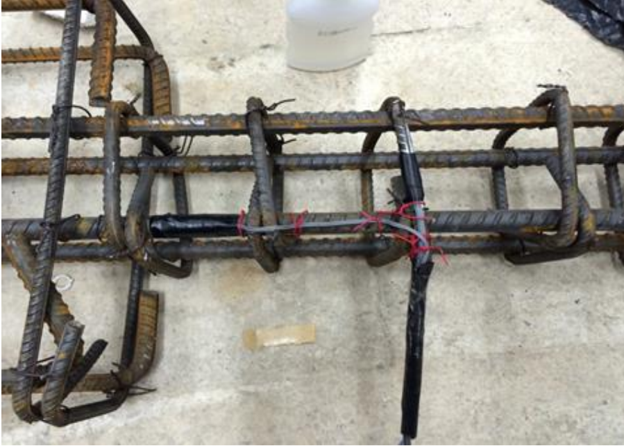
Şekil 3. 6. Şekildeğiştirmeölçerin bantlanarak dış etkenlerden korunması
