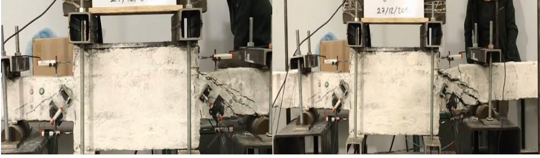
Şekil 4. 2. DS-O numunesinin deney sonlarına doğru hasar gelişimi
