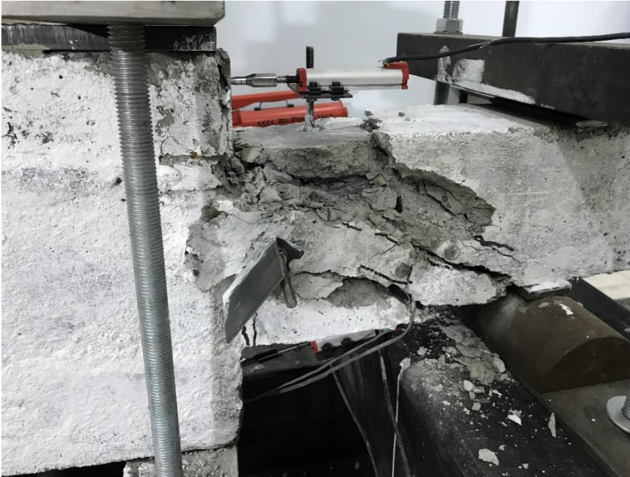
EK 3. 4. DS-O numunesinde kesme etkilerinden dolayı meydana gelen göçme şekli (Üst kolon ön yüzden görünüm)
