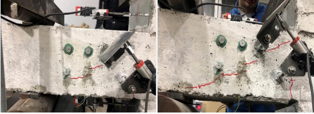
Şekil 4. 44. CCRS-R numunesinde oluşan ilk eğik kesme çatlağı
