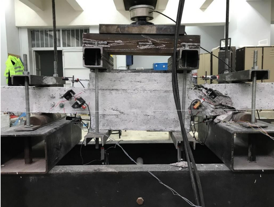
EK 3. 8. CCRS-O numunesinde kesme etkilerinden dolayı meydana gelen göçme şekli (Arka yüzden görünüm)
