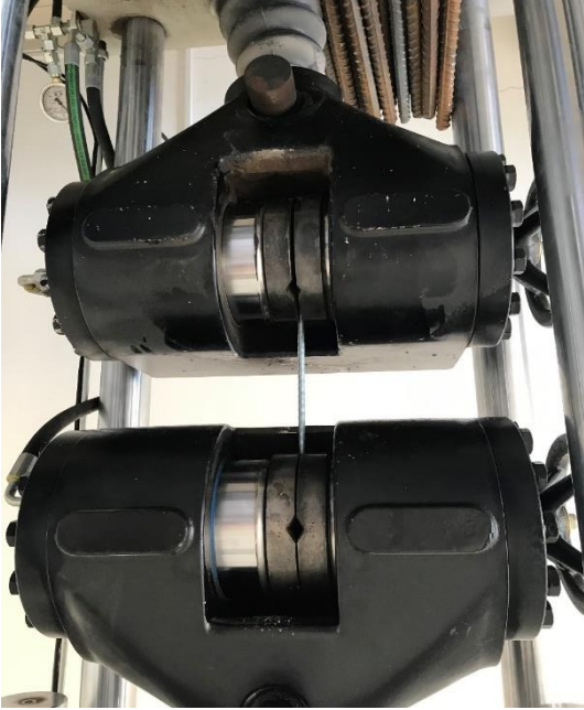
Şekil 3. 19. Çelik levha ankrajlanmasında kullanılan tij çekme deneyi
