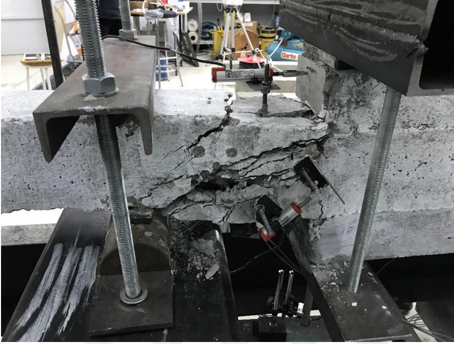
EK 3. 3. DS-O numunesinde kesme etkilerinden dolayı meydana gelen göçme şekli (Üst kolon arka yüzden görünüm)
