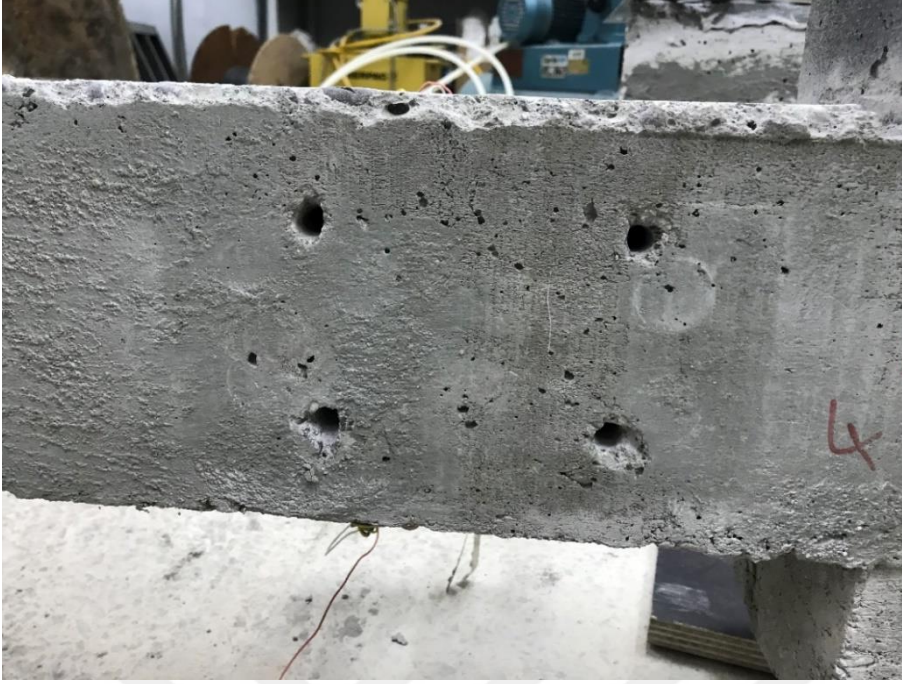
Şekil 3. 27. Ankraj deliklerinin açılması
