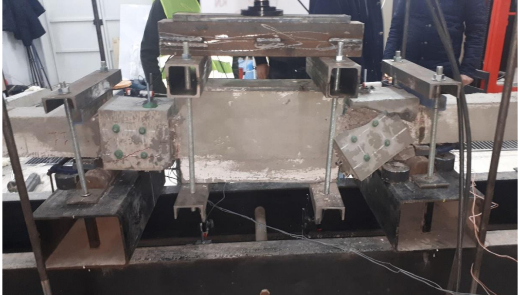
EK 3. 10. DS-R numunesi meydana gelen gcme Őekli (Arka yzden grnmm)
