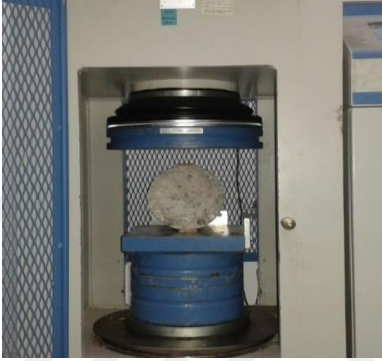
Şekil 3. 17. Disk yarma deneyi için düzenek
