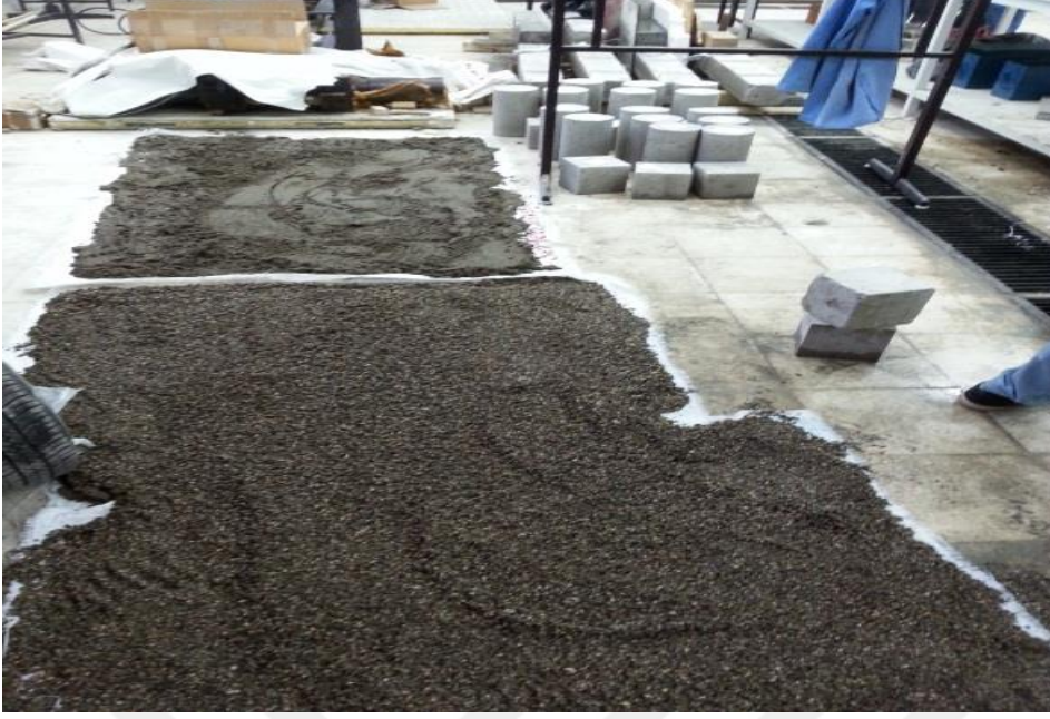
Şekil 3. 8. Agrega malzemesinin yıkanması ve hava ortamında kurutulmaya bırakılması
