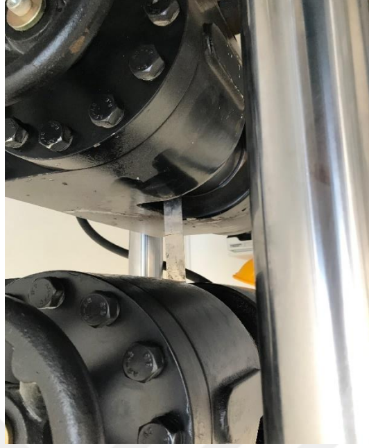
Şekil 3. 18. Çelik levha çekme deneyi
