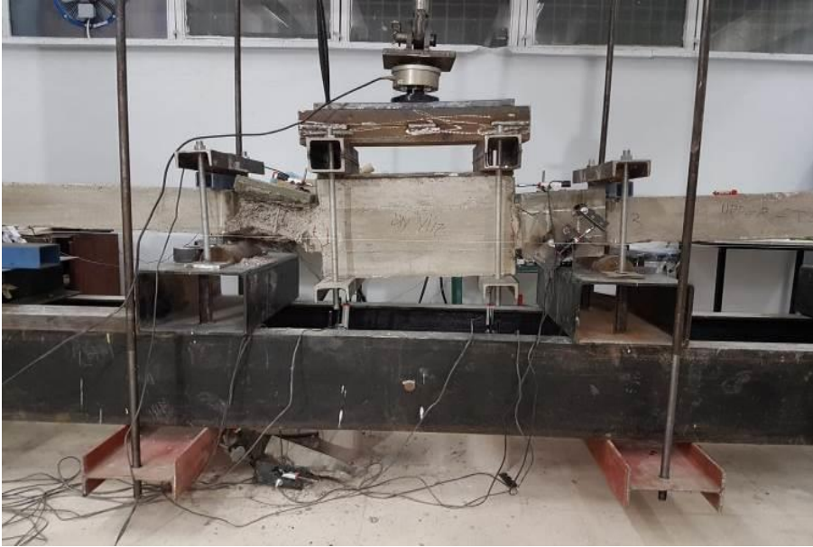
Şekil 4. 45. CCRS-R numunesinin deney sonlarına doğru hasar gelişimi
