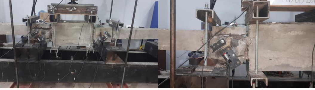
Şekil 4. 33. DS-R numunesinin deney sonlarına doğru hasar gelişimi
