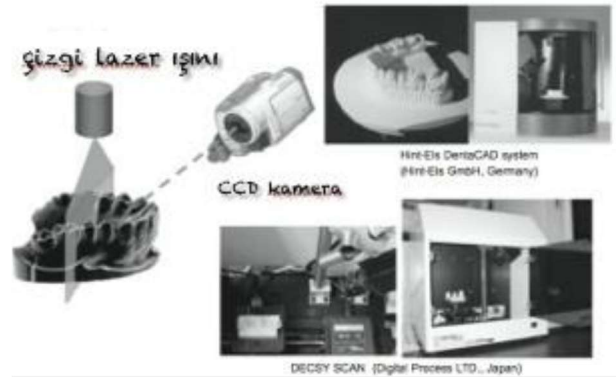
Şekil 6: CCD kamera ile verilerin alınması
