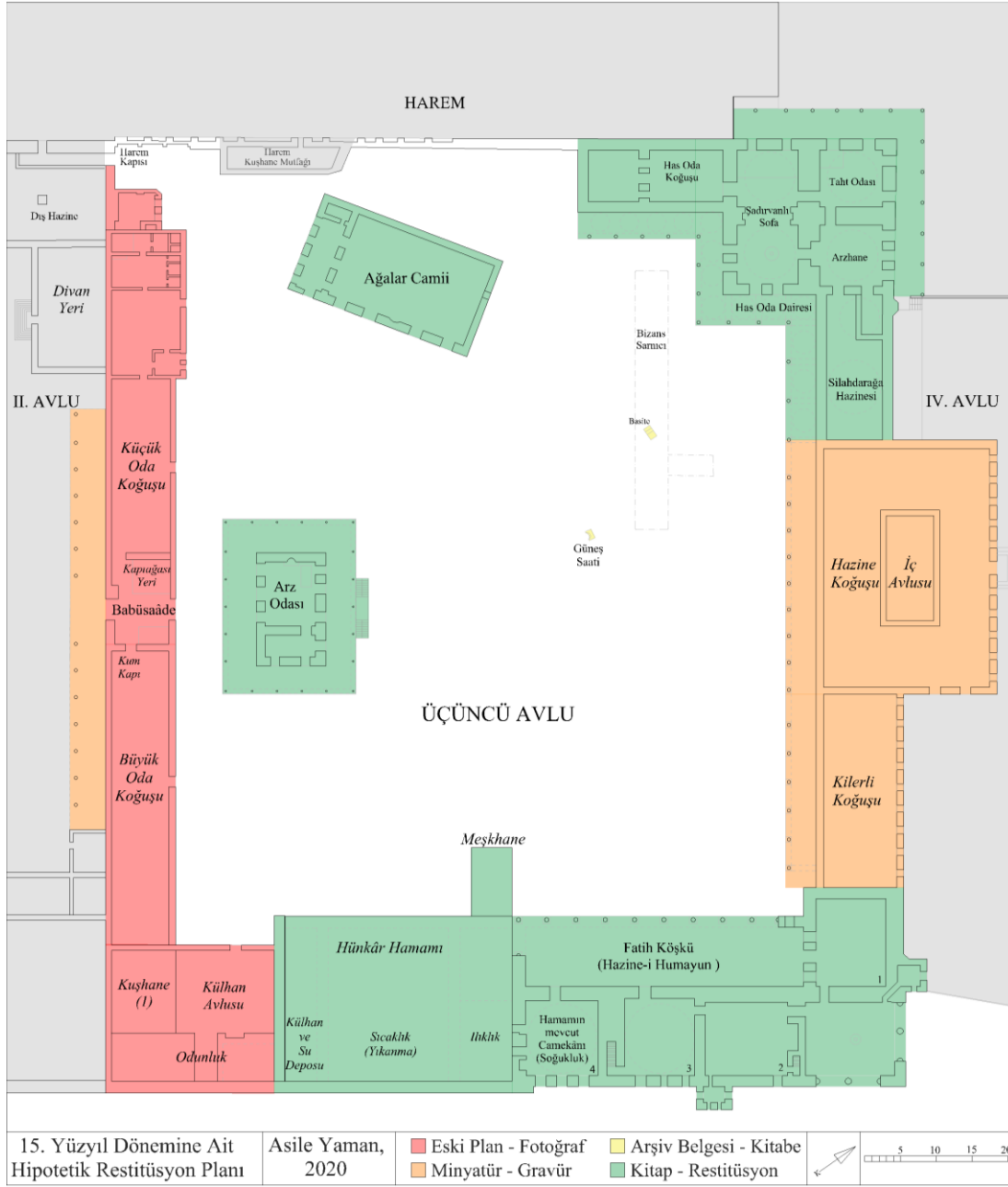
Görsel 414 15. Yüzyıl Dönemine Ait Veriler Doğrultusunda Hipotetik Restitüsyon Planı ve Güvenilirlik Lejantı, (Asile Yaman, 2020)
