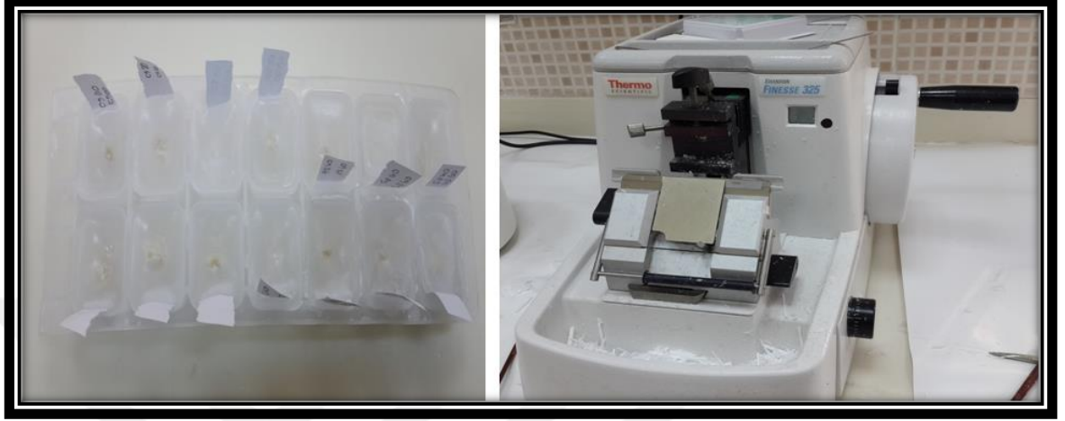
Resim 15. Hazırlanan parafin bloklar ve mikrotomda kesitlerin alınması
