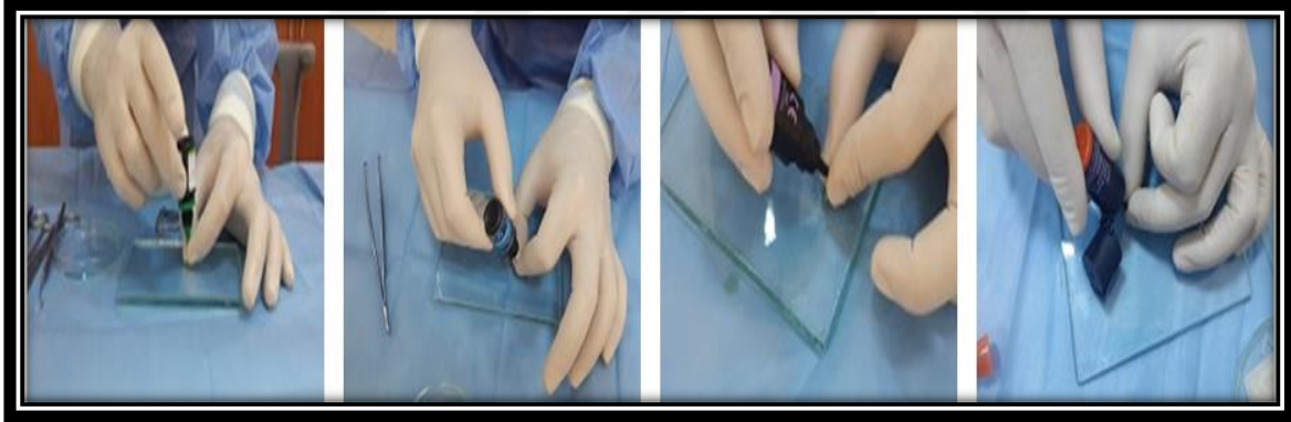
Resim 7. Dört farklı self-etch adezivin poliüretan tüplere yerleştirilmesi
