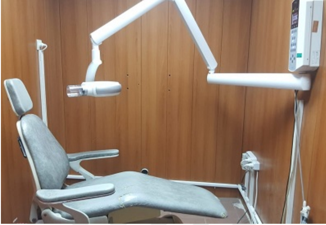
Resim 29. Periapikal röntgen cihazı ve fosfor plak tarayıcısı (XMind ünyity DC röntgen cihazı ve Acteon Sopro Pspix fosfor plak tarayıcı, Acteon Satalec, Germany)
