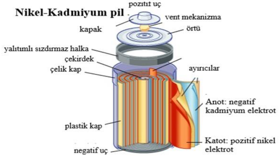
Şekil-1: Kadmiyum-nikel pillerin yapısı (220)
