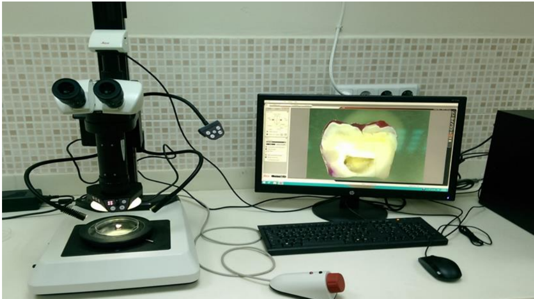
Resim 1: Kesitlerin incelendiği stereomikroskobun görüntüsü
