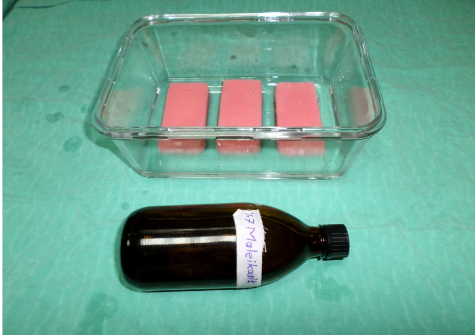
Resim 6: %7'lik maleik asit ile şelasyon işleminin görüntüsü
