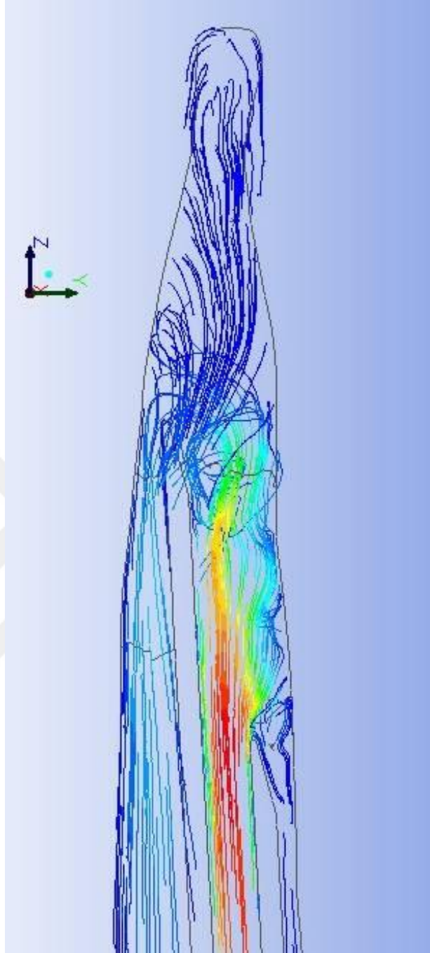
Resim 33. 30G iğnenin apekten 1 mm uzaklıktaki konumunda meydana gelen akış çizgileri.
