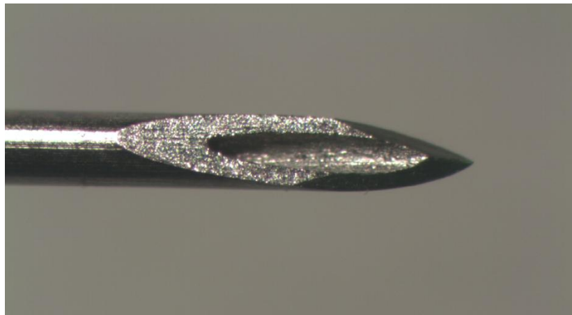
Resim 14. 30G iğnenin uç kısmının üstten optik mikroskop görüntüsü (x 50 büyütme).
