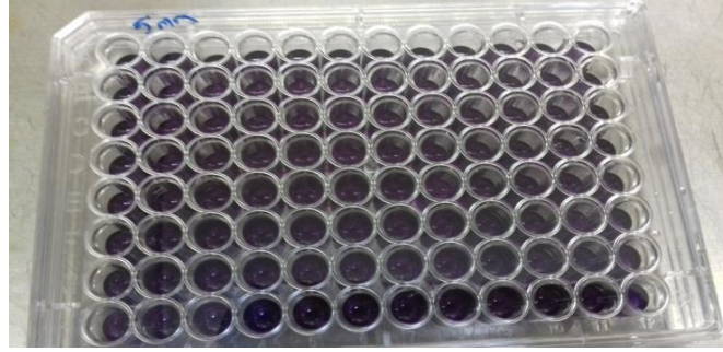
Resim 19. Kompozit rezin örneklerinden elde edilen salınım sıvılarının pleytlere yerleştirilmesi
