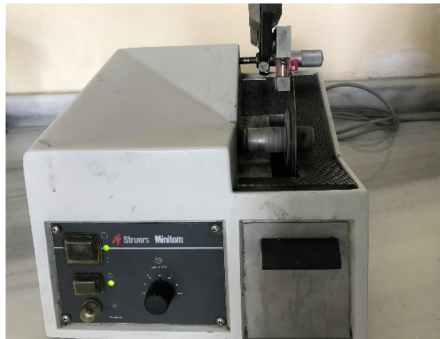
Resim.3.30. Minitom Cihazıyla Dişlerin Bukkolingual Yönde Kesilmesi
