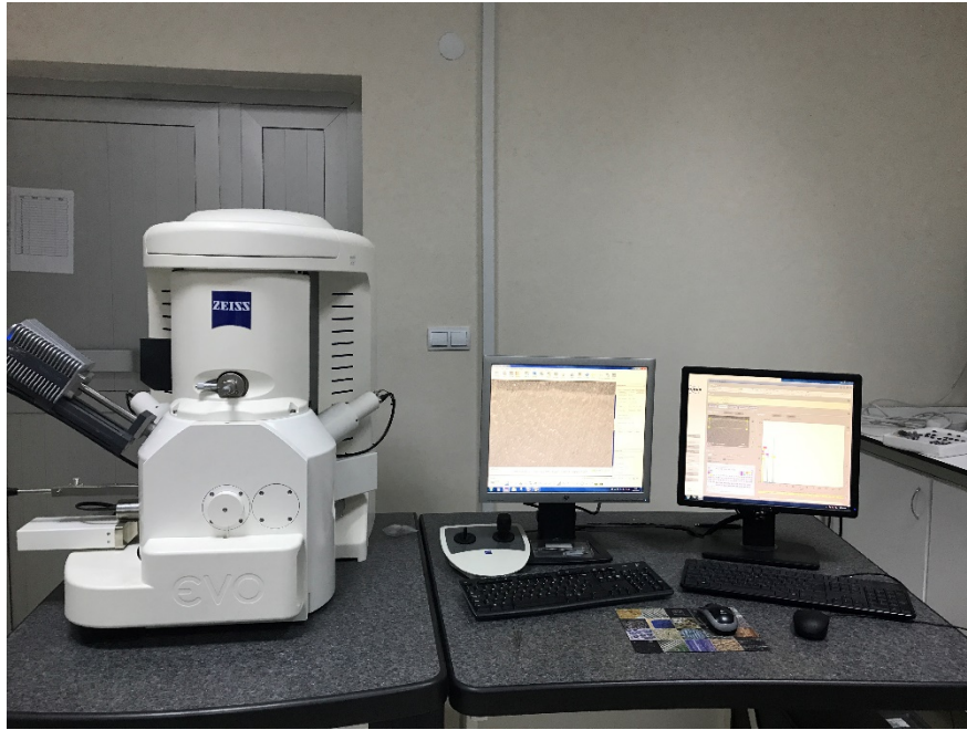
Resim.3.41. SEM Cihazı ve Bağlı Bulunduğu Bilgisayar Sistemi
