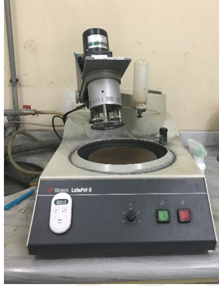
Resim.3.35. Örneklerin Zımparalama ve Parlatma İşlemlerinin Yapıldığı Cihaz
