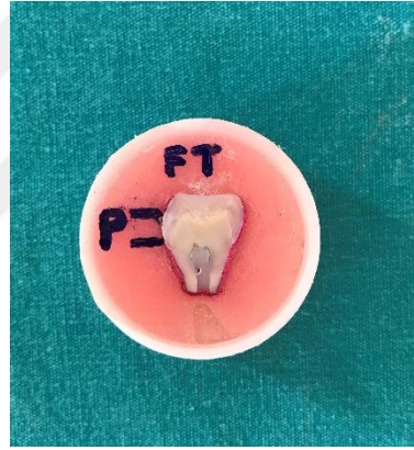
Resim.3.36. Cross-Sectional Mikrosertlik Ölçümüne Hazır Hale Gelmiş Diş Örneği
