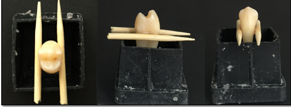
Resim 3.2.: Dişlerin plastik kalıplarda sabitlenmesi
