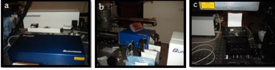
Resim 3.5. Tı:safir Fs lazer bileşenleri görülmektedir. a) amplifikatör b) lazer ışığını taşıyan aynaların bulunduğu düzenek c) mikro işleme ünitesi
