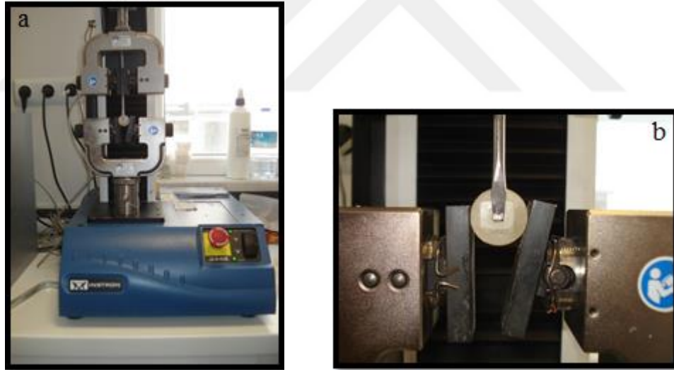
Resim 3.12. a) Üniversal Test Cihazı b) Koparma işlemi için yerleştirilen örnek
