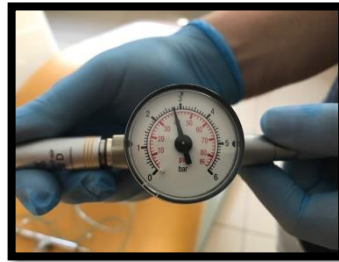
Resim 3.3. Kojet ile kumlama işlemi öncesi basıncın ayarlanması
