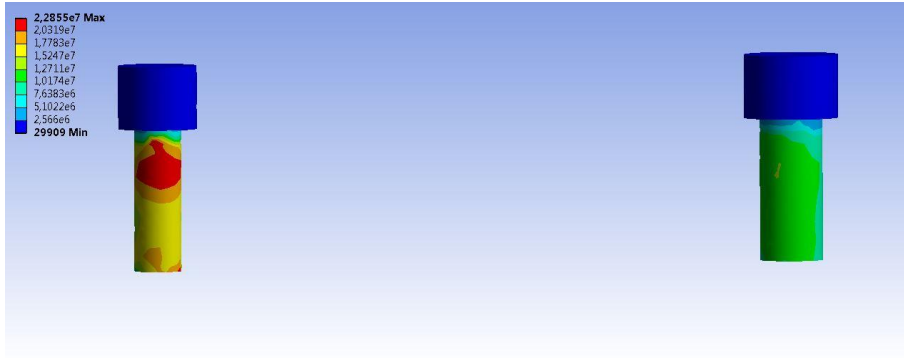
Şekil 4-59: Grup 3c' de dikey yükleme sonucunda titanyum vidalarda oluşan maksimum von Mises stres dağılımı
