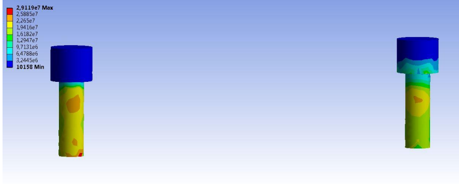
Şekil 4-17: Grup 1c' de dikey yükleme sonucunda titanyum vidalarda oluşan maksimum von Mises stres dağılımı
