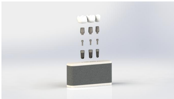
Şekil 3-11: Grup 2 için oluşturulan 3D modelin bileşenlerinin görüntüsü
