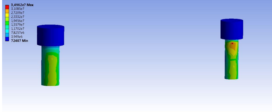
Şekil 4-115: Grup 3b' de oblik yükleme sonucunda titanyum vidalarda oluşan maksimum von Mises stres dağılımı
