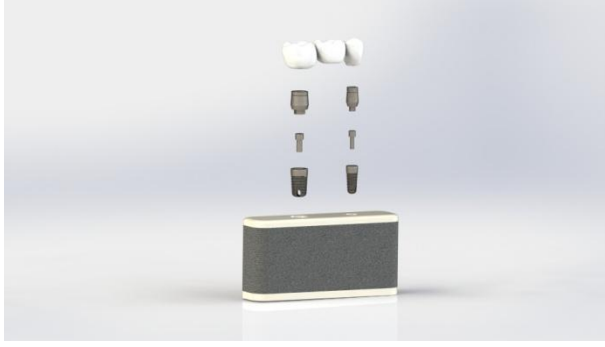
Şekil 3-13: Grup 3 için oluşturulan 3D modelin bileşenlerinin görüntüsü
