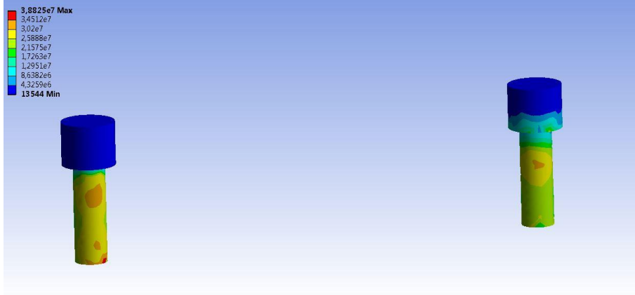
Şekil 4-3: Grup 1a' da dikey yükleme sonucunda titanyum vidalarda oluşan maksimum von Mises stres dağılımı
