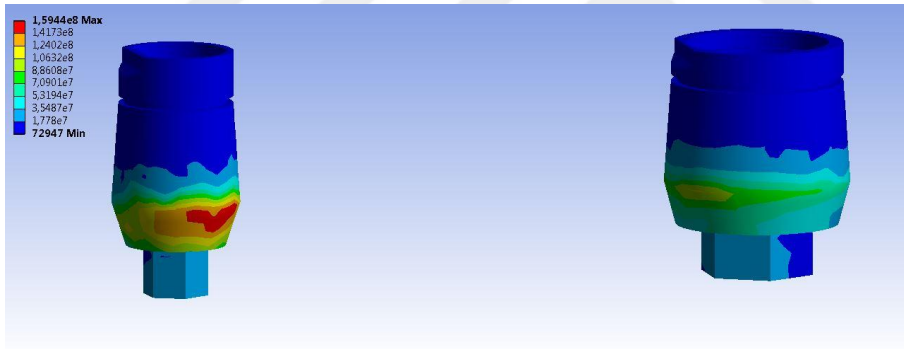
Şekil 4-51: Grup 3b' de dikey yükleme sonucunda titanyum abutmentlerde oluşan maksimum von Mises stres dağılımı
