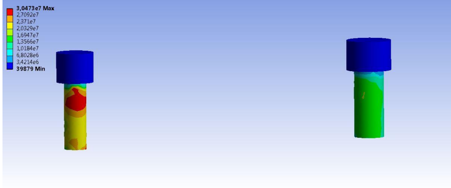
Şekil 4-45: Grup 3a' da dikey yükleme sonucunda titanyum vidalarda oluşan maksimum von Mises stres dağılımı
