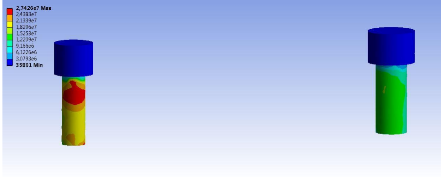
Şekil 4-52: Grup 3b' de dikey yükleme sonucunda titanyum vidalarda oluşan maksimum von Mises stres dağılımı
