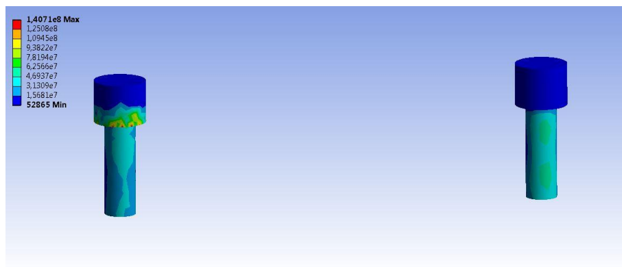
Şekil 4-73: Grup 1b' de oblik yükleme sonucunda titanyum vidalarda oluşan maksimum von Mises stres dağılımı
