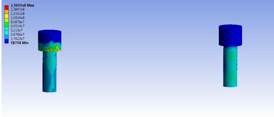
Şekil 4-66: Grup 1a' da oblik yükleme sonucunda titanyum vidalarda oluşan maksimum von Mises stres dağılımı
