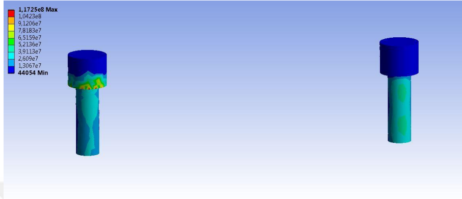
Şekil 4-80: Grup 1c' de oblik yükleme sonucunda titanyum vidalarda oluşan maksimum von Mises stres dağılımı
