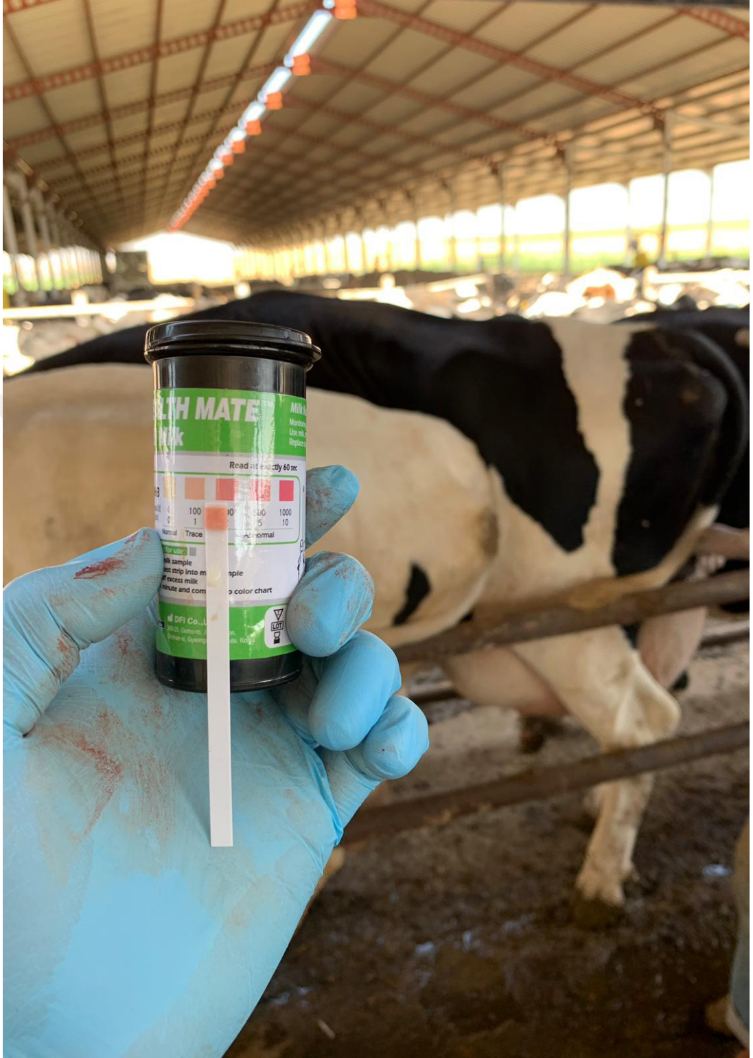
Resim 3. Sütte keton tespit uygulaması
