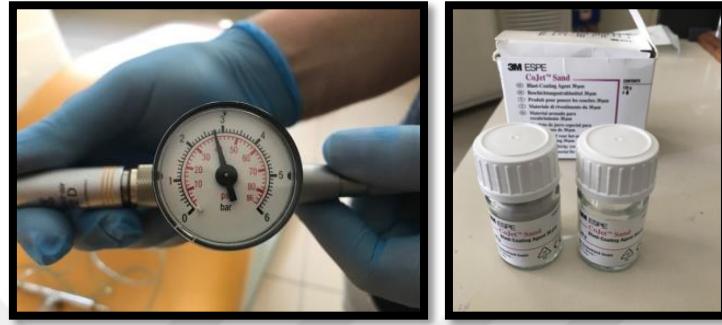
Resim 3.9. : Cojetin basıncını gösteren basınç ölçer ve cojet kumu
